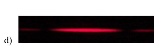
10. Laserska svjetlost prolazi kroz jednu usku pukotinu i daje ogibni uzorak na udaljenom zastoru.
