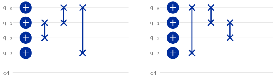
Slika 5.5: Kvantni krug koji mapira |x\rangle u |7^x \bmod 15\rangle (lijevo) odnosno u |13^x \bmod 15\rangle (desno). Slike su preuzete direktno iz IBM Quantum Composer -a.
