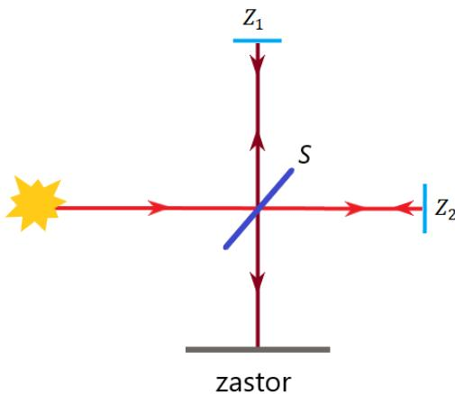
Slika 8.1: Shematski prikaz interferometra iz Michelson-Morleyeva eksperimenta.
