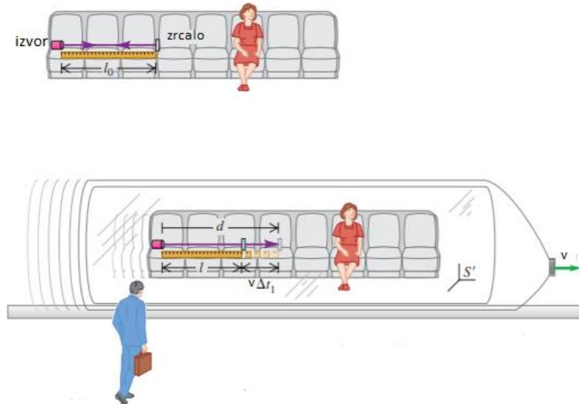
Slika 3: Duljina ravnala u oba inercijalna referentna sustava [6].
