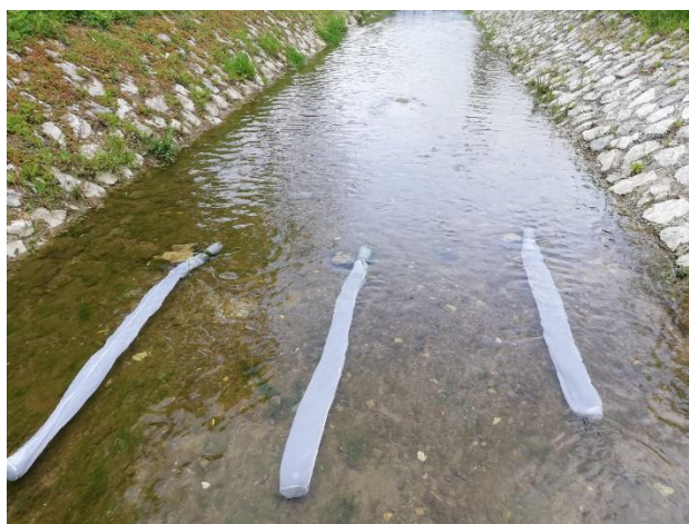
Slika 5. Drift-uzorkivači za vrijeme uzorkovanja drifta na postaji V1 (foto: Ines Maksimović)
