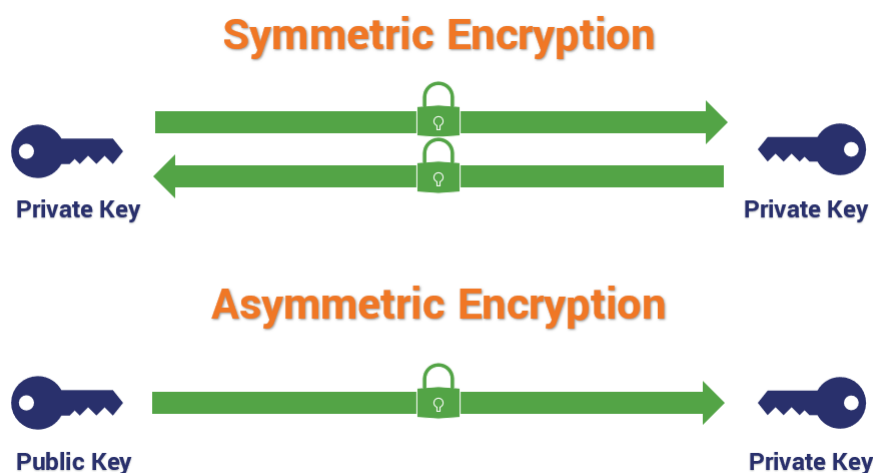
Slika 1.1: Šifriranje simetričnim i javnim ključem
