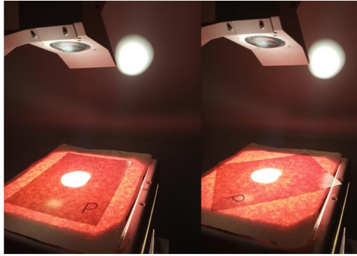
Slika 5.3: Polarizator postavljen na kružni otvor (lijevo) i zarotiran (desno).
