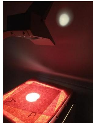
Slika 5.4: Zakretanje drugog polarizatora.
