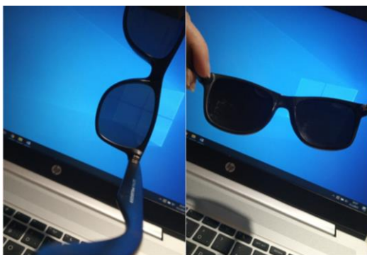
Slika 5.1: Pogled u ekran računala kroz polarizirajuće naočale za dva različita položaja naočala.
