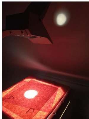
Slika 5.4: Zakretanje drugog polarizatora.
