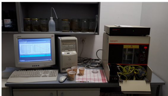
Slika 11. SediGraph 5100, Geološko-paleontološki zavod PMF-a.
