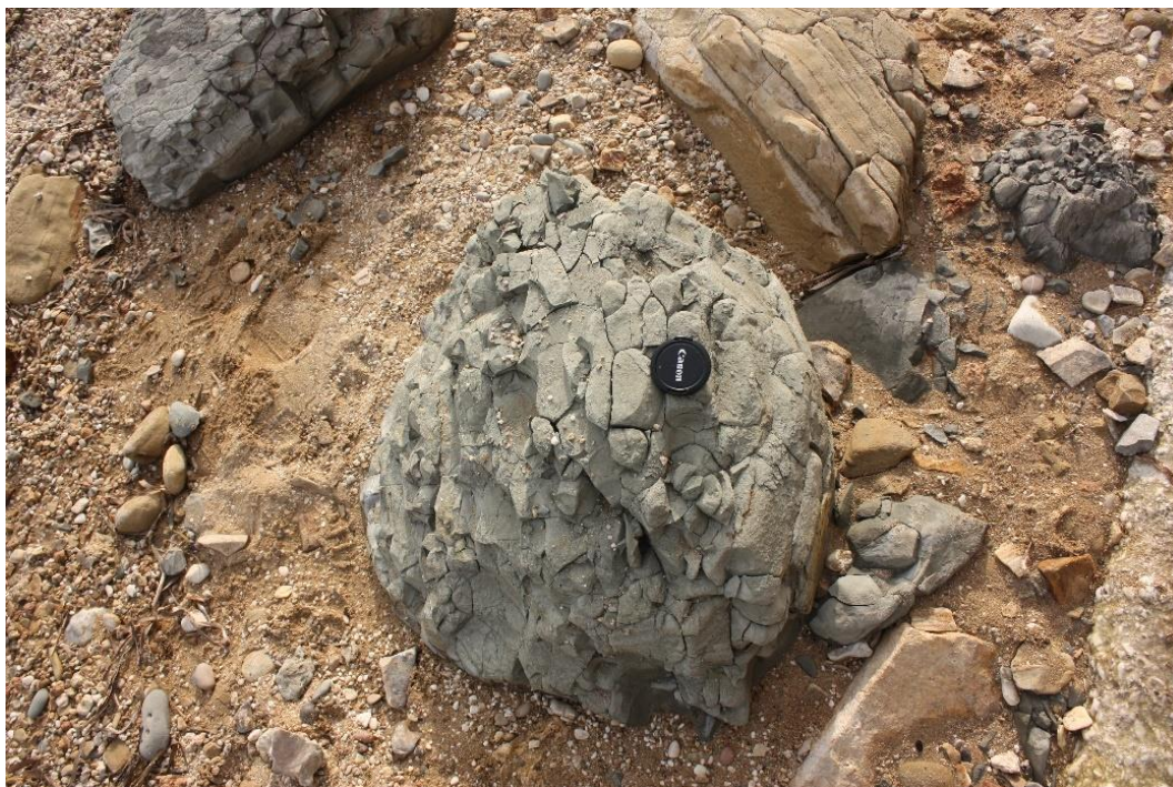
Slika 30. Trošenje komada lapora ( slaking ) u intertjaldalu pod utjecajem valova, veljača 2020.
