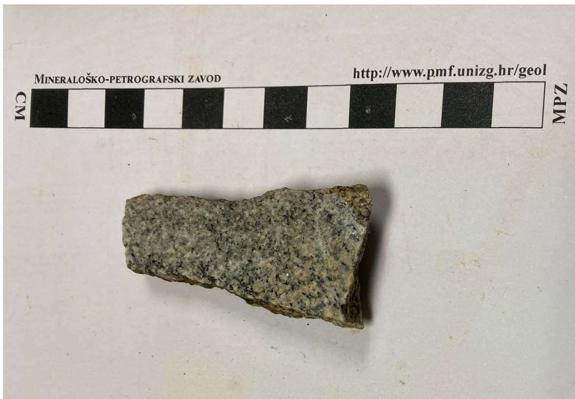
Slika 6 Makroskopski prikaz stijene iz kamenoloma „Zebrato“ na kojoj se jasno vidi homogena tekstura, uzorak G1
