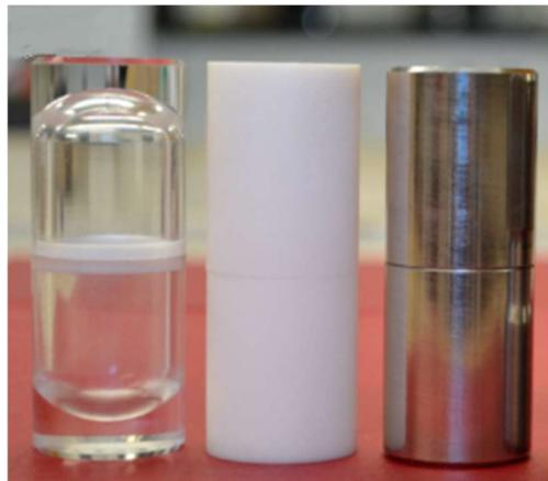
Slika 16. Različite vrste mehanokemijskih reakcijskih posudica (PMMA, teflon, nehrđajući čelik)<sup>42</sup>
