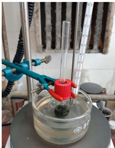
Slika 32. Prikaz aparature korištene za reakciju sinteze 2-fenilkinoksalina
