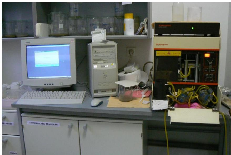
Slika 12 SediGraph 5100 korišten za granulometrijske analize frakcija  $<63 \mu\text{m}$ .
