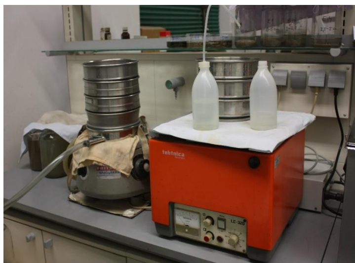
Slika 11 Sita i vibracijski aparat korišteni za mokro sijanje sedimenata.
