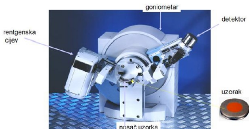
Slika 25. Prikaz goniometra suvremenog difraktometra 39
