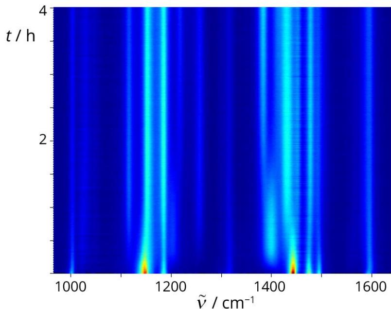
**Slika D3.** 2D prikaz vremenski razlučenog Ramanovog praćenja LAG reakcije **L1** (0,5 mmol), NBS (0,6 mmol),  $\text{Pd}(\text{OTs})_2(\text{MeCN})_2$  (40 mol %, 0,2 mmol),  $\text{TsOH} \times \text{H}_2\text{O}$  (0,25 mmol), MeCN (15  $\mu\text{L}$ ) i  $\text{SiO}_2$  (400 mg). *In situ* opažanje paladocikla **II1-I** kao međuproducta halogeniranja **L1** NBS-om kataliziranog s  $\text{Pd}(\text{OTs})_2(\text{MeCN})_2$  u čvrstom stanju.
