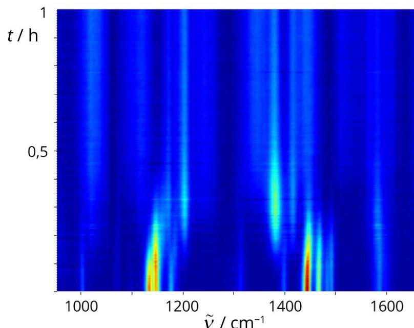
**Slika D24.** 2D prikaz vremenski razlučenog Ramanovog praćenja LAG reakcije **L3** (0,4 mmol) s  $\text{Pd}(\text{OAc})_2$  (0,42 mmol),  $\text{TsOH} \times \text{H}_2\text{O}$  (0,42 mmol), MeCN (25  $\mu\text{L}$ , 0,48 mmol) i  $\text{SiO}_2$  (250 mg).
