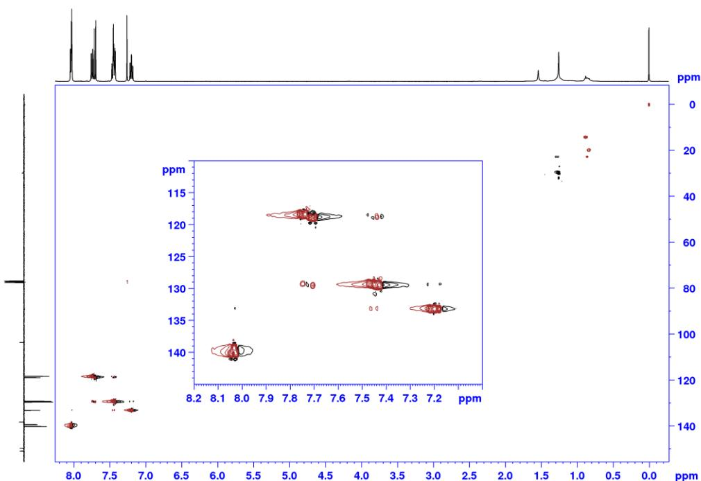
Slika D88. HSQC spektar L2I-II u  $\text{CDCl}_3$  (400 MHz).
