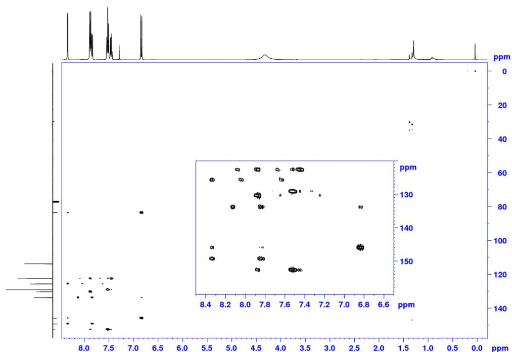
Slika D126. HMBC spektar L6Br-III u  $\text{CDCl}_3$  (400 MHz).
