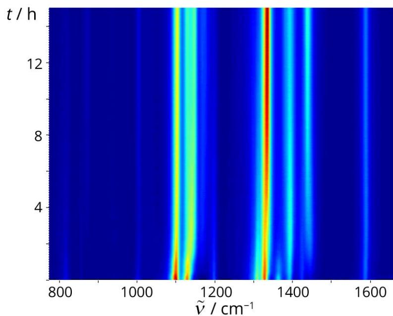
**Slika D39.** 2D prikaz vremenski razlučenog Ramanovog praćenja NG reakcije **L8** (0,5 mmol) s NCS-om (0,6 mmol) i SiO<sub>2</sub> (250 mg).
