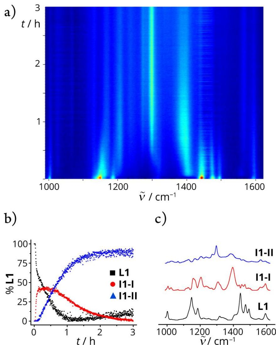
**Slika D17.** a) 2D prikaz vremenski razlučenog Ramanovog praćenja NG reakcije **L1** (0,4 mmol) s  $\text{Pd}(\text{OAc})_2$  (0,42 mmol),  $\text{TsOH} \times \text{H}_2\text{O}$  (0,8 mmol) i  $\text{SiO}_2$  (700 mg). b) Reakcijski profil dobiven MCR-ALS analizom. c) Ramanovi spektri vrsta opaženih tijekom Ramanovog praćenja reakcije dobiveni MCR-ALS analizom.
