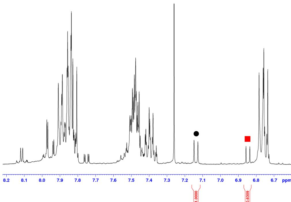
**Slika D48.** Aromatski dio  $^1\text{H}$  NMR spektra sirove reakcijske smjese kompeticijskog eksperimenta između **L7** i **L6** s NCS-om u  $\text{CDCl}_3$  (400 MHz).
