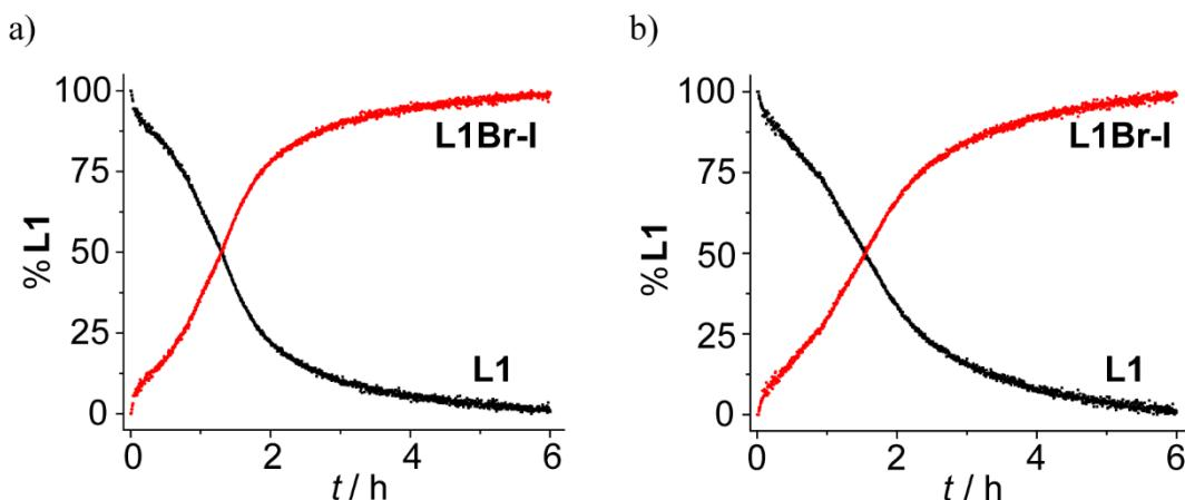
**Slika 53.** Reakcijski profili mehanokemijskih reakcija halogeniranja **L1** NBS-om uz katalizatore  $\text{Pd}(\text{II})$  dobiveni multivarijatnom metodom razlučivanja s naizmjeničnim izvođenjem metode najmanjih kvadrata (MCR-ALS). **L1** (0,5 mmol), NBS (0,6 mmol),  $\text{TsOH}\times\text{H}_2\text{O}$  (0,25 mmol), MeCN (15  $\mu\text{L}$ ) i a) **I1-I** (5 mol %) te b)  $\text{Pd}(\text{OAc})_2$  (5 mol %) kao katalizatori.
