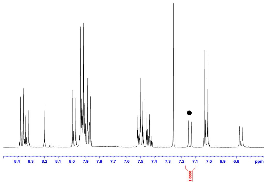
**Slika D53.** Aromatski dio <sup>1</sup>H NMR spektra sirove reakcijske smjese kompeticijskog eksperimenta između **L8** i **L5** s NBS-om u CDCl<sub>3</sub> (400 MHz).
