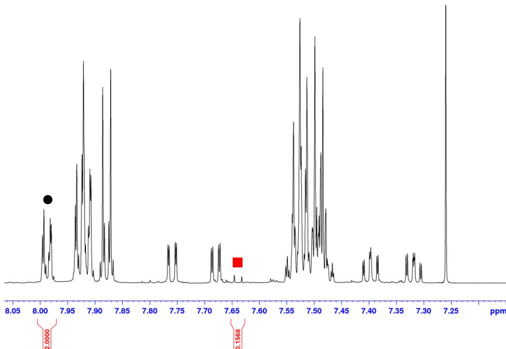
**Slika D42.** Aromatski dio <sup>1</sup>H NMR spektra sirove reakcijske smjese kompeticijskog eksperimenta između **L1** i **L2** s NBS-om u  $\text{CDCl}_3$  (400 MHz).
