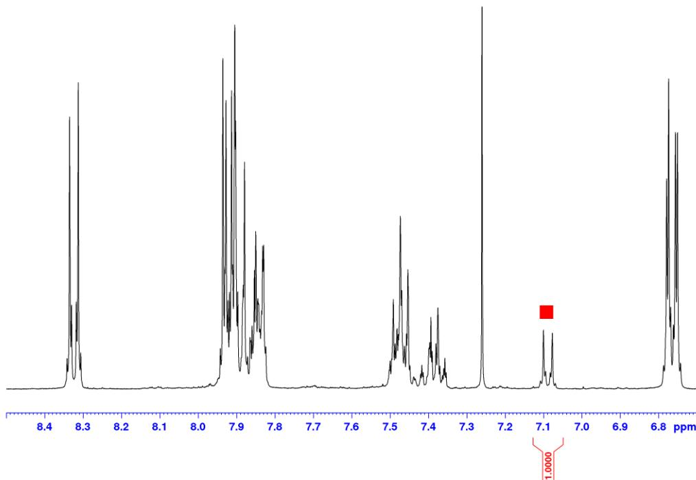
**Slika D54.** Aromatski dio  $^1\text{H}$  NMR spektra sirove reakcijske smjese kompeticijskog eksperimenta između **L8** i **L7** s NIS-om u  $\text{CDCl}_3$  (400 MHz).
