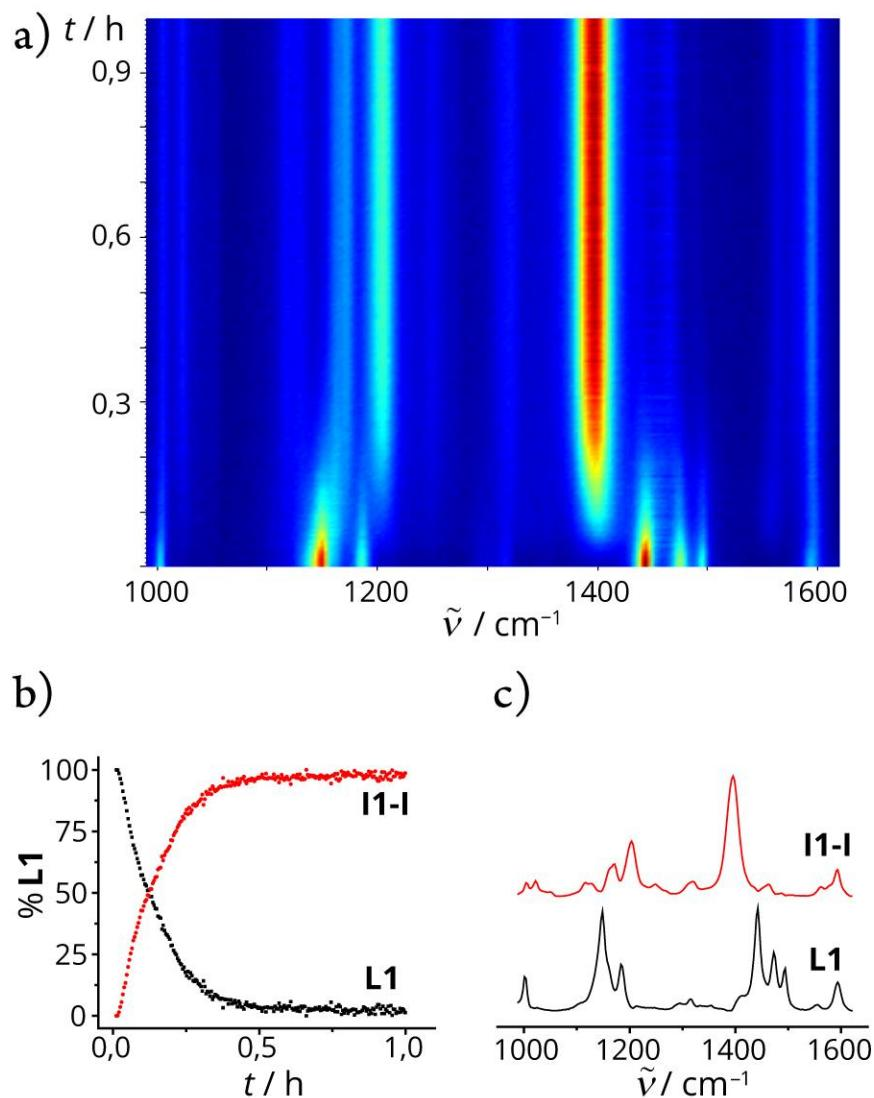
**Slika D13.** a) 2D prikaz vremenski razlučenog Ramanovog praćenja NG reakcije **L1** (0,4 mmol) s  $\text{Pd}(\text{OTs})_2(\text{MeCN})_2$  (0,42 mmol),  $\text{TsOH} \times \text{H}_2\text{O}$  (0,42 mmol) i  $\text{SiO}_2$  (400 mg). b) Reakcijski profil dobiven MCR-ALS analizom. c) Ramanovi spektri vrsta opaženih tijekom Ramanovog praćenja reakcije dobiveni MCR-ALS analizom.
