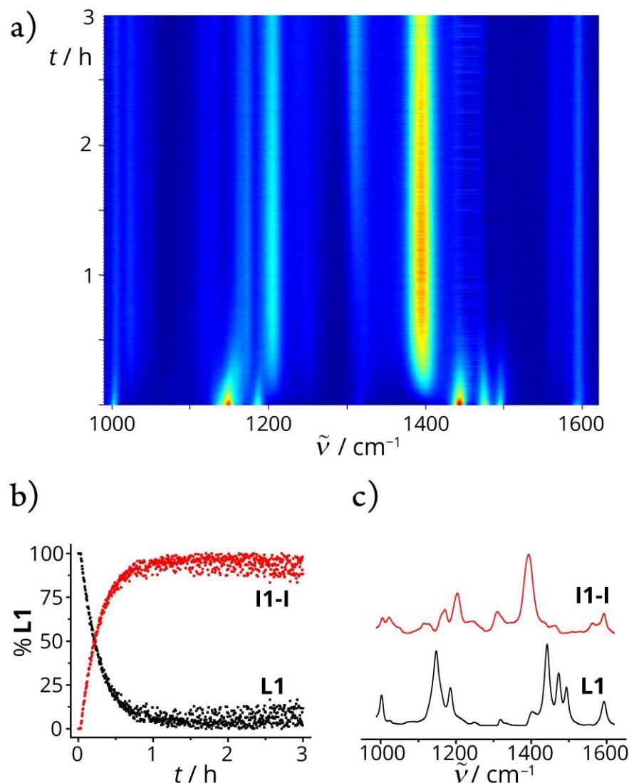
**Slika D15.** a) 2D prikaz vremenski razlučenog Ramanovog praćenja LAG reakcije **L1** (0,4 mmol) s  $\text{Pd}(\text{OAc})_2$  (0,42 mmol),  $\text{TsOH} \times \text{H}_2\text{O}$  (0,42 mmol), MeCN (25  $\mu\text{L}$ , 0,48 mmol) i  $\text{SiO}_2$  (400 mg). b) Reakcijski profil dobiven MCR-ALS analizom. c) Ramanovi spektri vrsta opaženih tijekom Ramanovog praćenja reakcije dobiveni MCR-ALS analizom.
