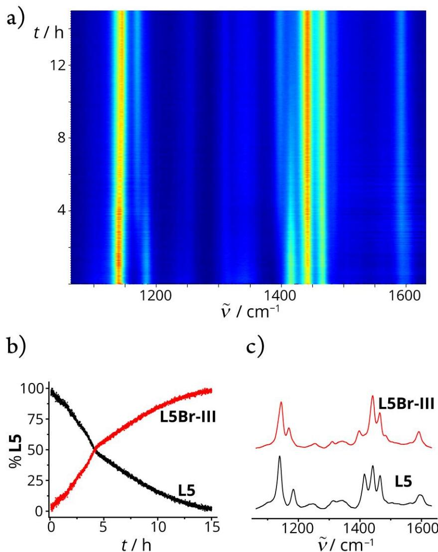
**Slika 64.** a) 2D prikaz vremenski razlučenog Ramanovog praćenja reakcije **L5** (0,5 mmol), NBS (0,6 mmol) i SiO<sub>2</sub> (250 mg). b) Reakcijski profil dobiven MCR-ALS analizom. c) Ramanovi spektri vrsta opaženih tijekom Ramanovog praćenja reakcije dobiveni MCR-ALS analizom.
