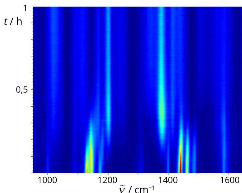
**Slika 61.** 2D prikaz vremenski razlučenog Ramanovog praćenja LAG reakcije **L2** (0,4 mmol) s  $\text{Pd}(\text{OAc})_2$  (0,42 mmol),  $\text{TsOH} \times \text{H}_2\text{O}$  (0,42 mmol), MeCN (25  $\mu\text{L}$ , 0,48 mmol) i  $\text{SiO}_2$  (250 mg).
