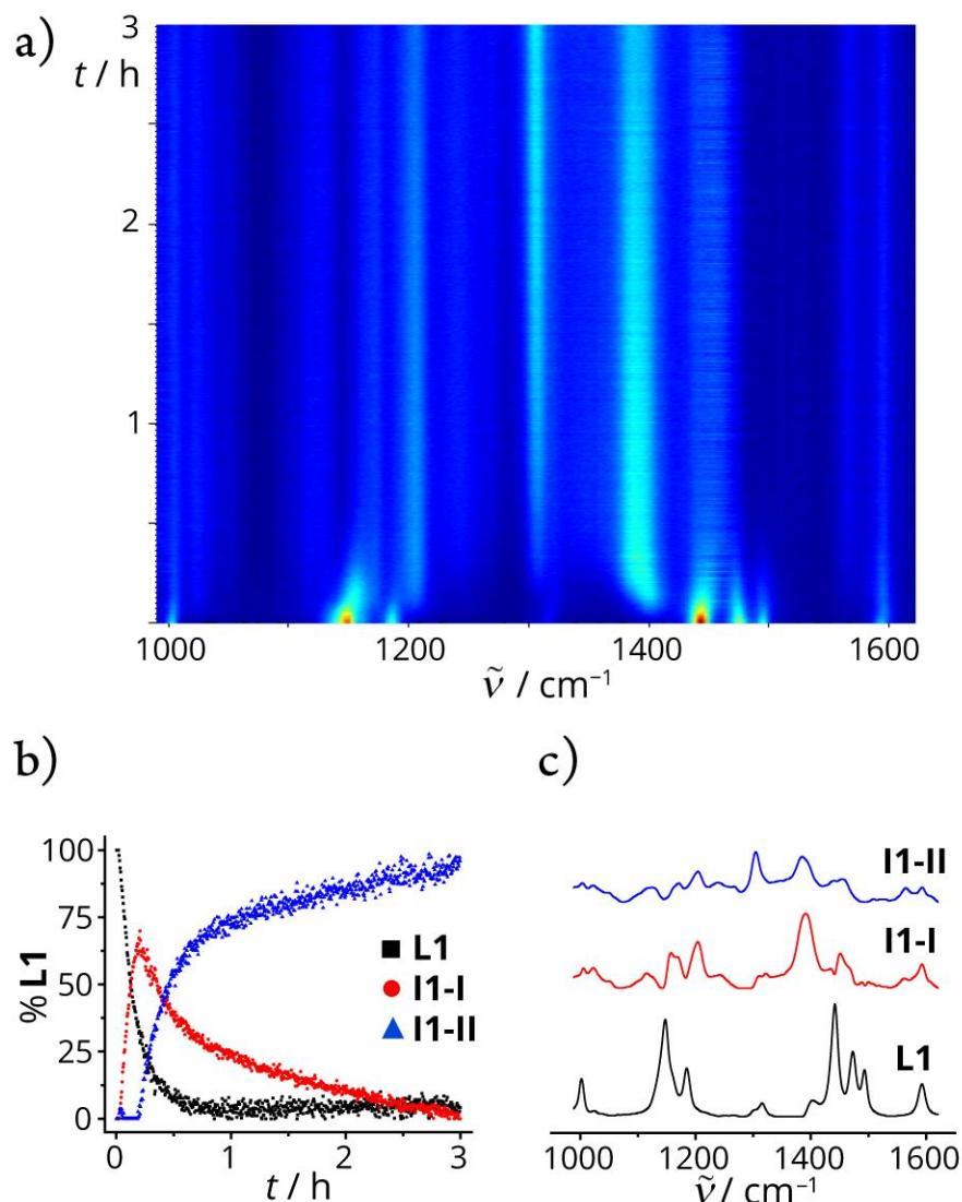
**Slika D18.** a) 2D prikaz vremenski razlučenog Ramanovog praćenja LAG reakcije **L1** (0,4 mmol) s  $\text{Pd}(\text{OAc})_2$  (0,42 mmol),  $\text{TsOH} \times \text{H}_2\text{O}$  (0,42 mmol),  $\text{H}_2\text{O}$  (25  $\mu\text{L}$ ) i  $\text{SiO}_2$  (400 mg). b) Reakcijski profil dobiven MCR-ALS analizom. c) Ramanovi spektri vrsta opaženih tijekom Ramanovog praćenja reakcije dobiveni MCR-ALS analizom.
