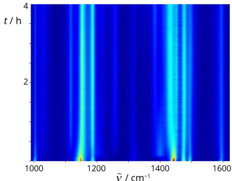
**Slika D1.** 2D prikaz vremenski razlučenog Ramanovog praćenja LAG reakcije **L1** (0,5 mmol), NBS (0,6 mmol),  $\text{Pd}(\text{OAc})_2$  (30 mol %, 0,15 mmol),  $\text{TsOH} \times \text{H}_2\text{O}$  (0,25 mmol), MeCN (15  $\mu\text{L}$ ) i  $\text{SiO}_2$  (250 mg). *In situ* opažanje paladocikla **II-I** kao međuproducta halogeniranja **L1** NBS-om kataliziranog s  $\text{Pd}(\text{OAc})_2$  u čvrstom stanju.
