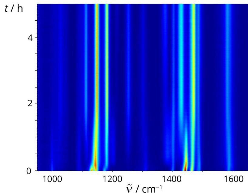
**Slika D21.** 2D prikaz vremenski razlučenog Ramanovog praćenja LAG reakcije **L2** (0,5 mmol) s NBS-om (0,6 mmol),  $\text{Pd}(\text{OTs})_2(\text{MeCN})_2$  (30 mol %, 0,15 mmol),  $\text{TsOH} \times \text{H}_2\text{O}$  (0,25 mmol), MeCN (15  $\mu\text{L}$ ) i  $\text{SiO}_2$  (400 mg). *In situ* opažanje paladocikla **I2-I** kao međuproducta halogeniranja **L2** NBS-om kataliziranog s  $\text{Pd}(\text{OTs})_2(\text{MeCN})_2$  u čvrstom stanju.
