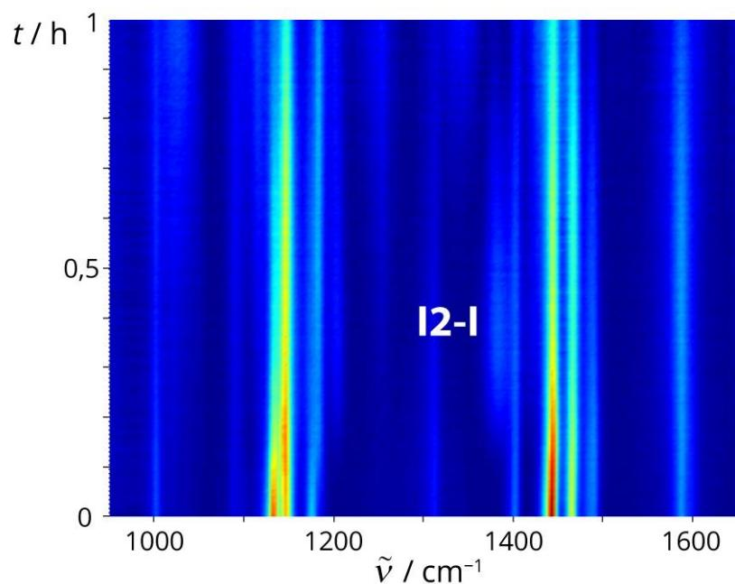
**Slika 62.** 2D prikaz vremenski razlučenog Ramanovog praćenja reakcije **L2** (0,5 mmol), NBS (0,6 mmol), Pd(OAc)<sub>2</sub> (30 mol %, 0,15 mmol), TsOH×H<sub>2</sub>O (0,25 mmol), MeCN (15 μL) i SiO<sub>2</sub> (250 mg). *In situ* opažanje paladocikla **I2-I** kao međuproducta halogeniranja **L2** NBS-om kataliziranog s Pd(OAc)<sub>2</sub> u čvrstom stanju.
