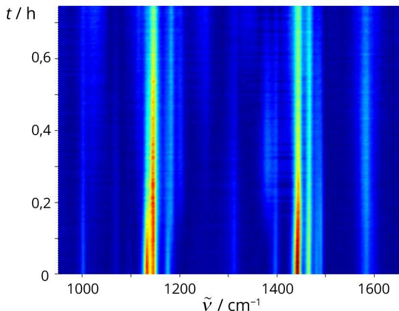
**Slika D19.** 2D prikaz vremenski razlučenog Ramanovog praćenja LAG reakcije **L3** (0,5 mmol) s NBS-om (0,6 mmol),  $\text{Pd}(\text{OAc})_2$  (30 mol %, 0,15 mmol),  $\text{TsOH} \times \text{H}_2\text{O}$  (0,25 mmol), MeCN (15  $\mu\text{L}$ ) i  $\text{SiO}_2$  (250 mg). *In situ* opažanje paladocikla **I3-I** kao međuproducta halogeniranja **L3** NBS-om kataliziranog s  $\text{Pd}(\text{OAc})_2$  u čvrstom stanju.
