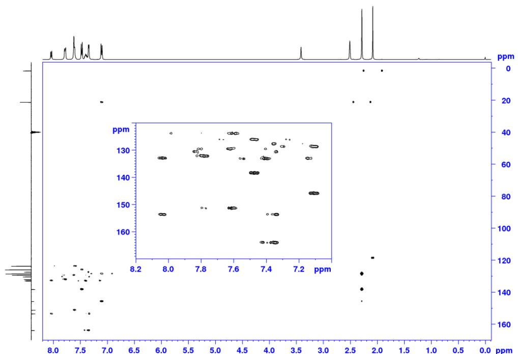
Slika D166. HMBC spektar II-I u  $\text{DMSO}-d_6$  (400 MHz).
