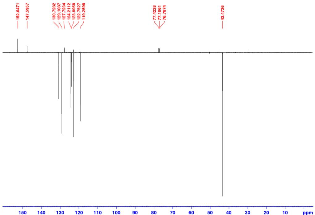
Slika D128.  $^{13}\text{C}$  NMR spektar L7Cl-III u  $\text{CDCl}_3$  (101 MHz).
