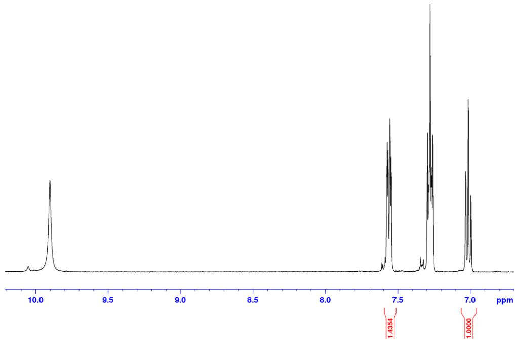
**Slika D57.** Aromatski dio <sup>1</sup>H NMR spektra pročišćenih reaktanata za određivanje KIE mehanokemijskog kloriranja **L10** u DMSO-*d*<sub>6</sub> (400 MHz).
