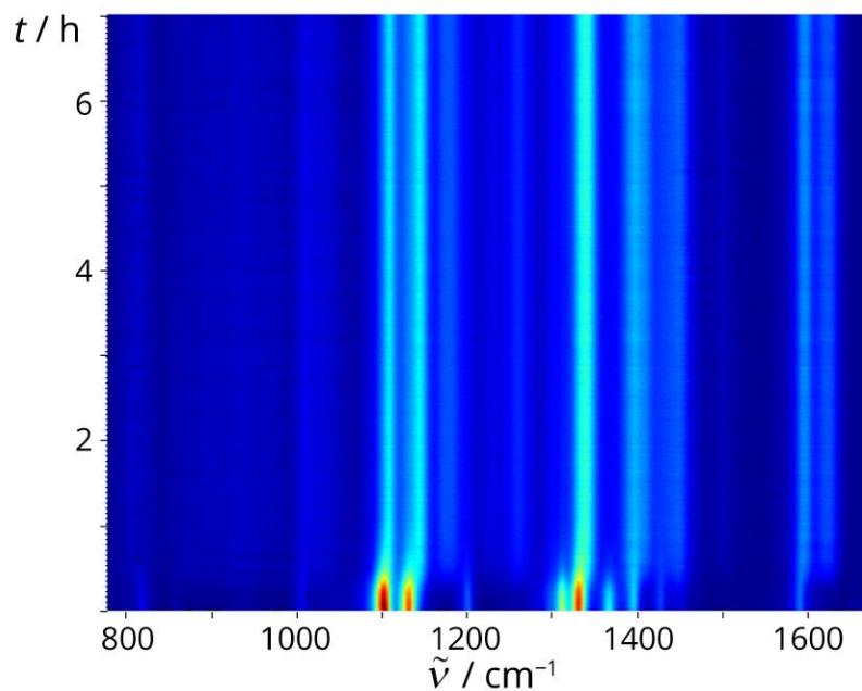
**Slika D40.** 2D prikaz vremenski razlučenog Ramanovog praćenja NG reakcije **L8** (0,5 mmol) s NBS-om (0,6 mmol) i SiO<sub>2</sub> (250 mg).
