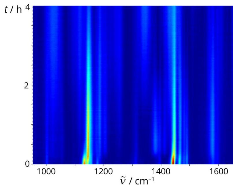
**Slika D20.** 2D prikaz vremenski razlučenog Ramanovog praćenja LAG reakcije **L4** (0,5 mmol) s NBS-om (0,6 mmol),  $\text{Pd}(\text{OAc})_2$  (30 mol %, 0,15 mmol),  $\text{TsOH} \times \text{H}_2\text{O}$  (0,25 mmol), MeCN (15  $\mu\text{L}$ ) i  $\text{SiO}_2$  (250 mg). *In situ* opažanje paladocikla **I4-I** kao međuproducta halogeniranja **L4** NBS-om kataliziranog s  $\text{Pd}(\text{OAc})_2$  u čvrstom stanju.
