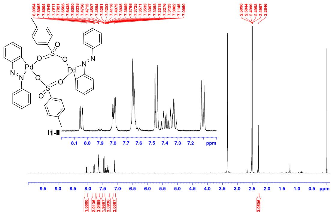
**Slika D167.**  $^1\text{H}$  NMR spektar **I1-II** u  $\text{DMSO}-d_6$  (400 MHz).  $\text{DMSO}-d_6$  kao snažno donorskog otapalo cijepa dimernu strukturu **I1-II** u monomernu nakon otapanja **I1-II** u  $\text{DMSO}-d_6$ .
