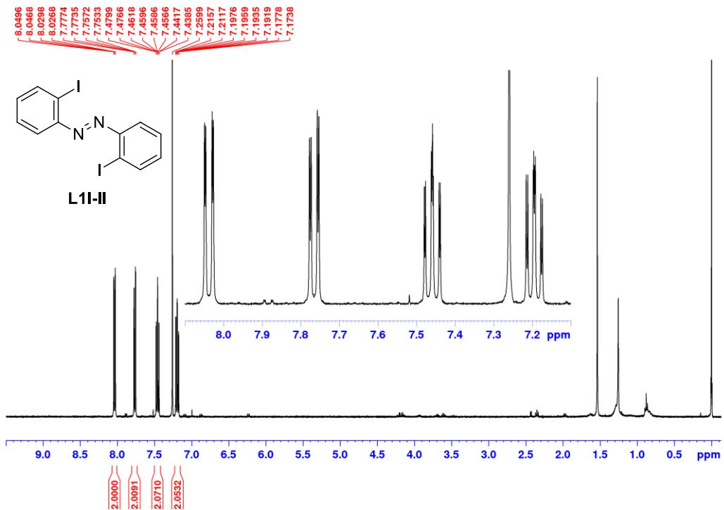
Slika D69.  $^1\text{H}$  NMR spektar L1I-II u  $\text{CDCl}_3$  (400 MHz).
