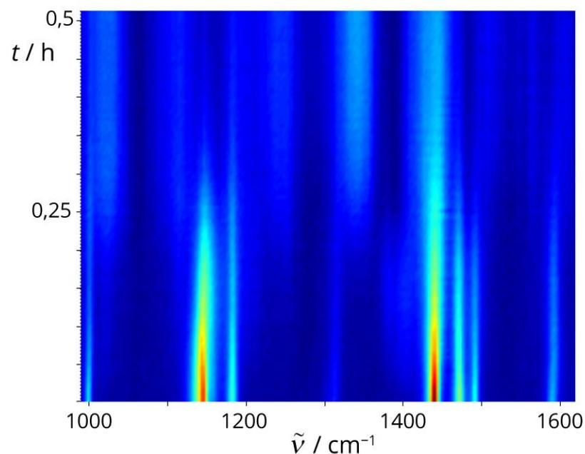
**Slika D5.** 2D prikaz vremenski razlučenog Ramanovog praćenja NG reakcije **L1** (0,5 mmol), NBS (0,6 mmol),  $\text{Pd}(\text{OAc})_2$  (30 mol %, 0,15 mmol),  $\text{TsOH} \times \text{H}_2\text{O}$  (0,25 mmol) i  $\text{SiO}_2$  (250 mg). Prikazani su samo Ramanovi spektri prije fluorescencije.
