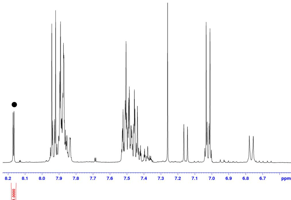
**Slika D50.** Aromatski dio <sup>1</sup>H NMR spektra sirove reakcijske smjese kompeticijskog eksperimenta između **L7** i **L5** s NBS-om u CDCl<sub>3</sub> (400 MHz).
