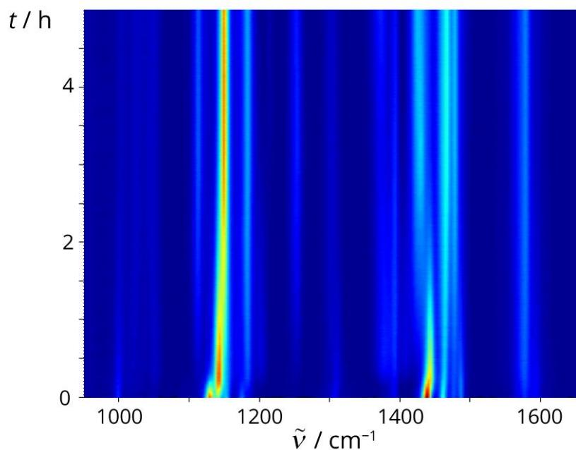
**Slika D23.** 2D prikaz vremenski razlučenog Ramanovog praćenja LAG reakcije **L4** (0,5 mmol) s NBS-om (0,6 mmol),  $\text{Pd}(\text{OTs})_2(\text{MeCN})_2$  (30 mol %, 0,15 mmol),  $\text{TsOH} \times \text{H}_2\text{O}$  (0,25 mmol), MeCN (15  $\mu\text{L}$ ) i  $\text{SiO}_2$  (400 mg). *In situ* opažanje paladocikla **I4-I** kao međuproducta halogeniranja **L4** NBS-om kataliziranog s  $\text{Pd}(\text{OTs})_2(\text{MeCN})_2$  u čvrstom stanju.
