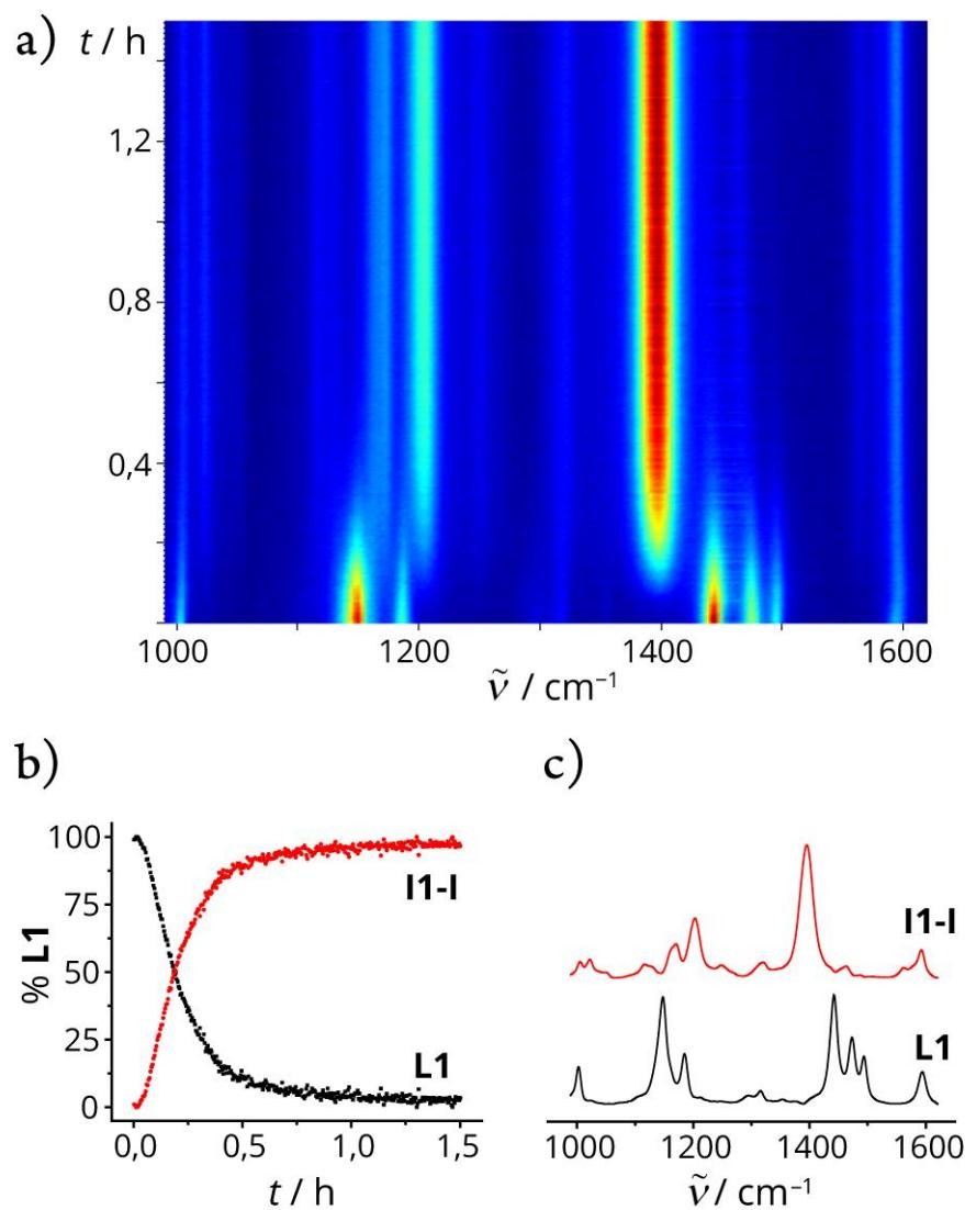
**Slika 57.** a) 2D prikaz vremenski razlučenog Ramanovog praćenja LAG reakcije **L1** (0,4 mmol),  $\text{Pd}(\text{OTs})_2(\text{MeCN})_2$  (0,42 mmol), MeCN (25  $\mu\text{L}$ , 0,48 mmol) i  $\text{SiO}_2$  (400 mg). b) Reakcijski profil dobiven MCR-ALS analizom. c) Ramanovi spektri vrsta opaženih tijekom Ramanovog praćenja reakcije dobiveni MCR-ALS analizom.
