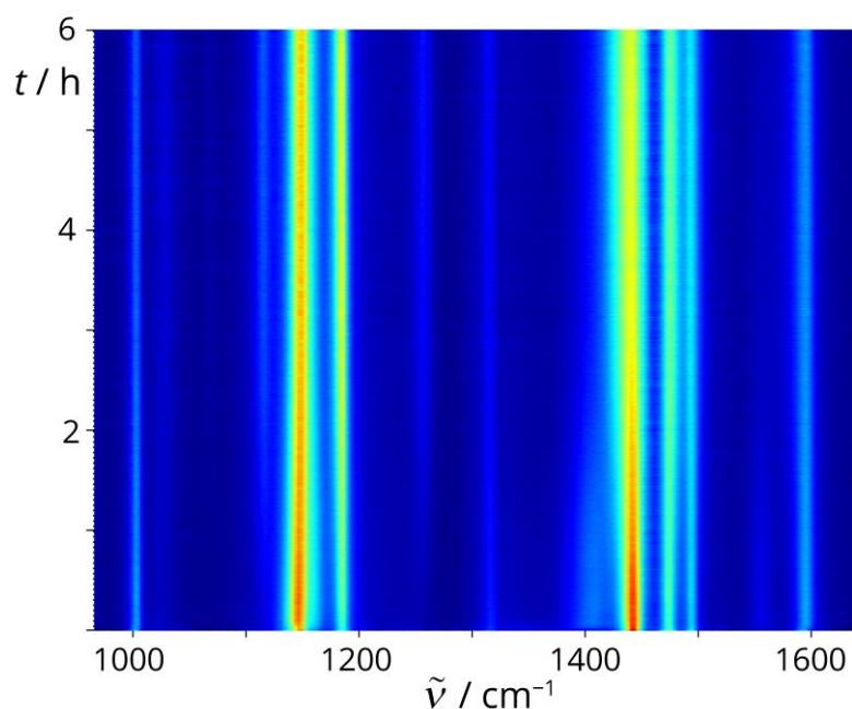
**Slika D9.** 2D prikaz vremenski razlučenog Ramanovog praćenja LAG reakcije **L1** (0,5 mmol) s NBS (0,6 mmol), **I1-II** (0,0125 mmol), TsOH×H<sub>2</sub>O (0,25 mmol) i SiO<sub>2</sub> (250 mg).
