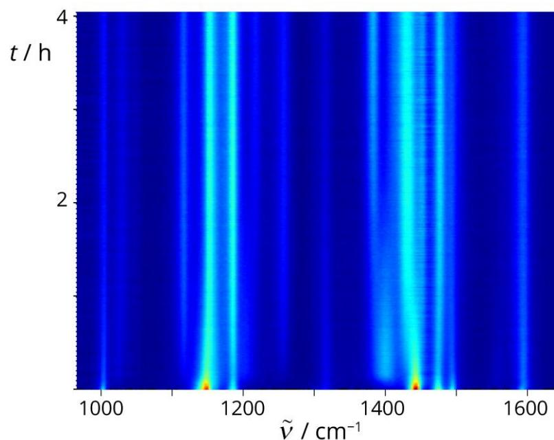
**Slika D4.** 2D prikaz vremenski razlučenog Ramanovog praćenja NG reakcije **L1** (0,5 mmol), NBS (0,6 mmol),  $\text{Pd}(\text{OTs})_2(\text{MeCN})_2$  (30 mol %, 0,15 mmol),  $\text{TsOH} \times \text{H}_2\text{O}$  (0,25 mmol) i  $\text{SiO}_2$  (250 mg). *In situ* opažanje paladocikla **I1-I** kao međuproducta halogeniranja **L1** NBS-om kataliziranog s  $\text{Pd}(\text{OTs})_2(\text{MeCN})_2$  u čvrstom stanju.
