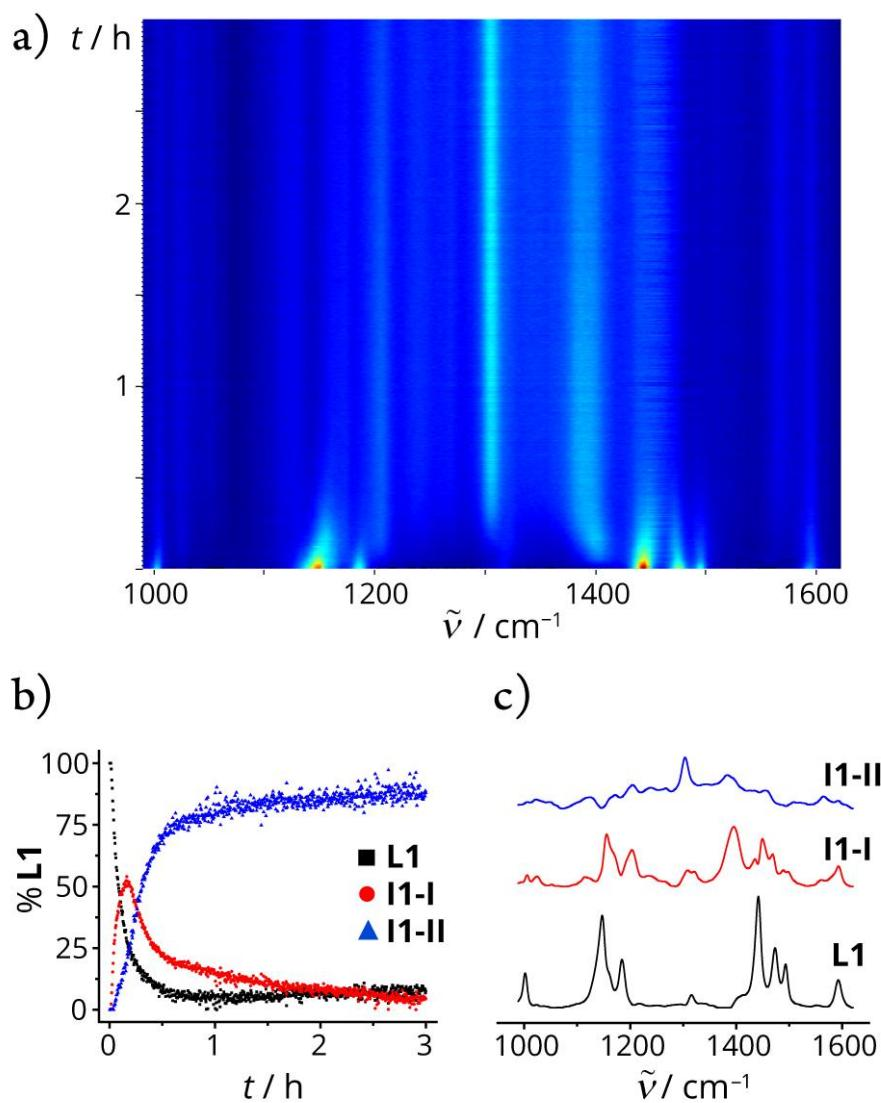
**Slika 58.** a) 2D prikaz vremenski razlučenog Ramanovog praćenja NG reakcije **L1** (0,4 mmol),  $\text{Pd}(\text{OAc})_2$  (0,42 mmol),  $\text{TsOH} \times \text{H}_2\text{O}$  (0,42 mmol) i  $\text{SiO}_2$  (400 mg). b) Reakcijski profil dobiven MCR-ALS analizom. c) Ramanovi spektri vrsta opaženih tijekom Ramanovog praćenja reakcije dobiveni MCR-ALS analizom.
