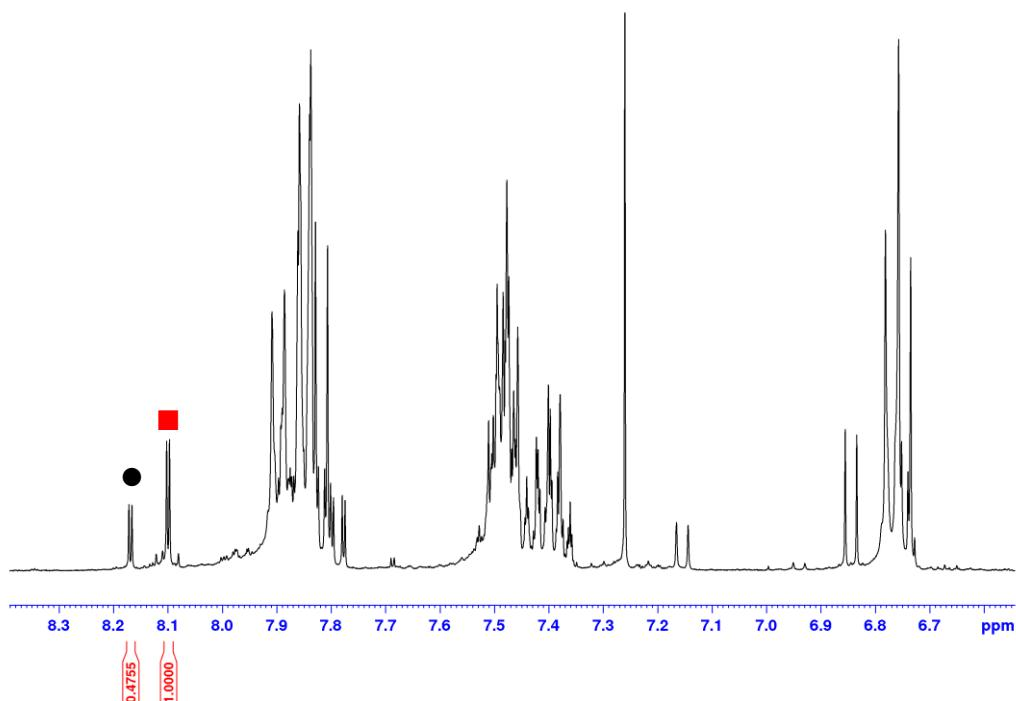
**Slika D51.** Aromatski dio  $^1\text{H}$  NMR spektra sirove reakcijske smjese kompeticijskog eksperimenta između **L7** i **L6** s NBS-om u  $\text{CDCl}_3$  (400 MHz).
