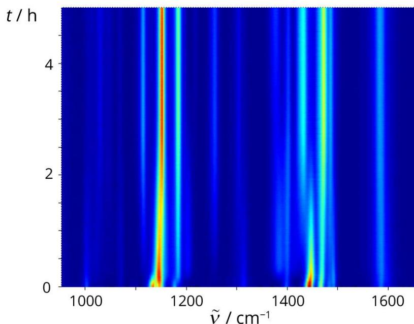
**Slika D22.** 2D prikaz vremenski razlučenog Ramanovog praćenja LAG reakcije **L3** (0,5 mmol) s NBS-om (0,6 mmol),  $\text{Pd}(\text{OTs})_2(\text{MeCN})_2$  (30 mol %, 0,15 mmol),  $\text{TsOH} \times \text{H}_2\text{O}$  (0,25 mmol), MeCN (15  $\mu\text{L}$ ) i  $\text{SiO}_2$  (400 mg). *In situ* opažanje paladocikla **I3-I** kao međuproducta halogeniranja **L3** NBS-om kataliziranog s  $\text{Pd}(\text{OTs})_2(\text{MeCN})_2$  u čvrstom stanju.
