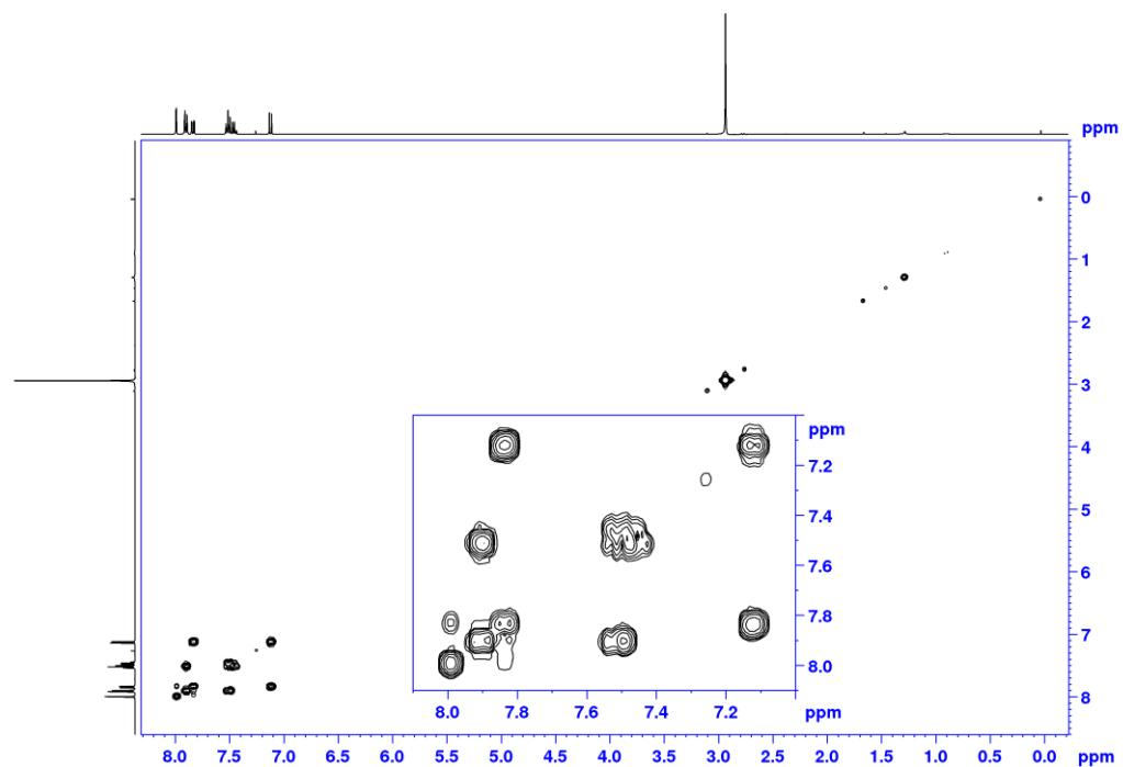
Slika D129. COSY spektar L7Cl-III u CDCl<sub>3</sub> (400 MHz).
