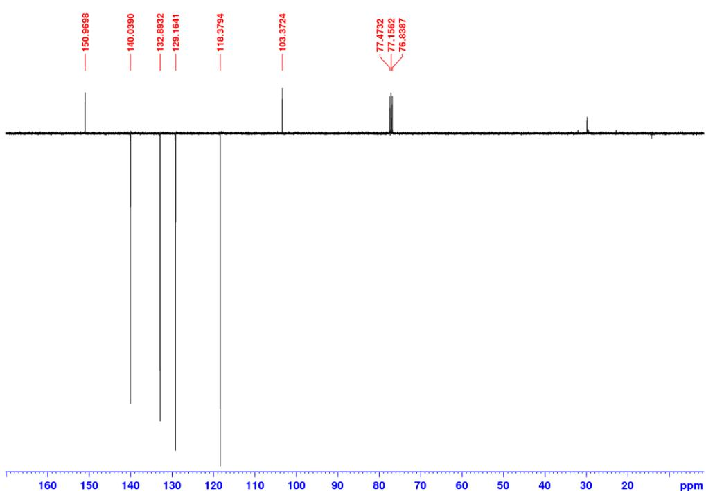
Slika D70.  $^{13}\text{C}$  NMR spektar L1I-II u  $\text{CDCl}_3$  (101 MHz).
