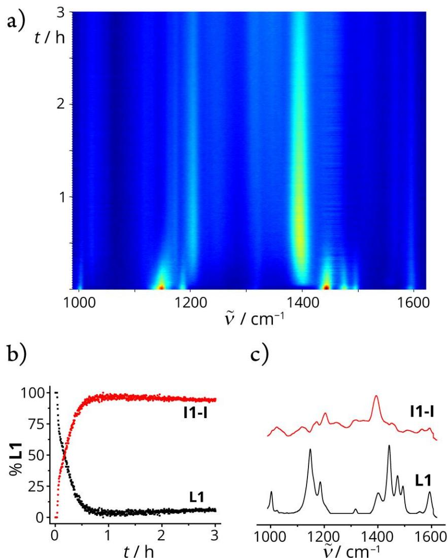
**Slika D16.** a) 2D prikaz vremenski razlučenog Ramanovog praćenja LAG reakcije **L1** (0,4 mmol) s  $\text{Pd}(\text{OAc})_2$  (0,42 mmol),  $\text{TsOH} \times \text{H}_2\text{O}$  (0,8 mmol), MeCN (25  $\mu\text{L}$ , 0,48 mmol) i  $\text{SiO}_2$  (700 mg). b) Reakcijski profil dobiven MCR-ALS analizom. c) Ramanovi spektri vrsta opaženih tijekom Ramanovog praćenja reakcije dobiveni MCR-ALS analizom.
