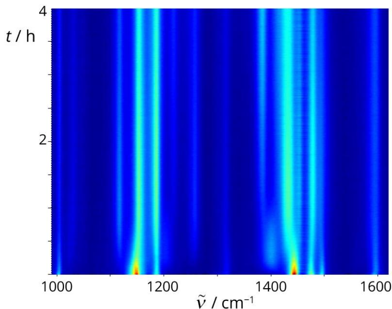
**Slika D2.** 2D prikaz vremenski razlučenog Ramanovog praćenja LAG reakcije **L1** (0,5 mmol), NBS (0,6 mmol),  $\text{Pd}(\text{OTs})_2(\text{MeCN})_2$  (30 mol %, 0,15 mmol),  $\text{TsOH} \times \text{H}_2\text{O}$  (0,25 mmol), MeCN (15  $\mu\text{L}$ ) i  $\text{SiO}_2$  (400 mg). *In situ* opažanje paladocikla **II1-I** kao međuproducta halogeniranja **L1** NBS-om kataliziranog s  $\text{Pd}(\text{OTs})_2(\text{MeCN})_2$  u čvrstom stanju.
