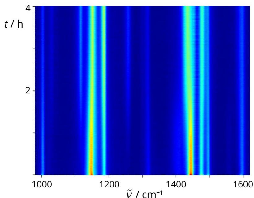
**Slika 49.** 2D prikaz vremenski razlučenog Ramanovog praćenja reakcije **L1** (0,5 mmol), NBS (0,6 mmol), Pd(OAc)<sub>2</sub> (5 mol %, 0,025 mmol), TsOH×H<sub>2</sub>O (0,25 mmol), MeCN (15 μL) i SiO<sub>2</sub> (250 mg).
