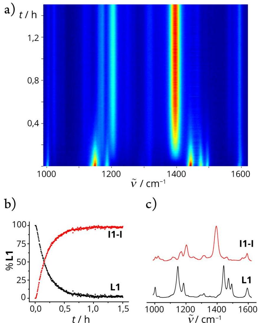
**Slika D12.** a) 2D prikaz vremenski razlučenog Ramanovog praćenja NG reakcije **L1** (0,4 mmol) s  $\text{Pd}(\text{OTs})_2(\text{MeCN})_2$  (0,42 mmol) i  $\text{SiO}_2$  (400 mg). b) Reakcijski profil dobiven MCR-ALS analizom. c) Ramanovi spektri vrsta opaženih tijekom Ramanovog praćenja reakcije dobiveni MCR-ALS analizom.
