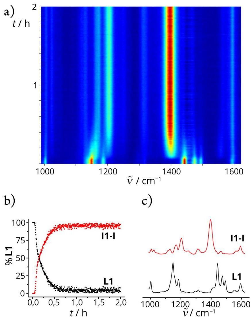
**Slika D14.** a) 2D prikaz vremenski razlučenog Ramanovog praćenja NG reakcije **L1** (0,4 mmol) s  $\text{Pd}(\text{OTs})_2(\text{MeCN})_2$  (0,42 mmol),  $\text{TsOH} \times \text{H}_2\text{O}$  (0,8 mmol) i  $\text{SiO}_2$  (700 mg). b) Reakcijski profil dobiven MCR-ALS analizom. c) Ramanovi spektri vrsta opaženih tijekom Ramanovog praćenja reakcije dobiveni MCR-ALS analizom.
