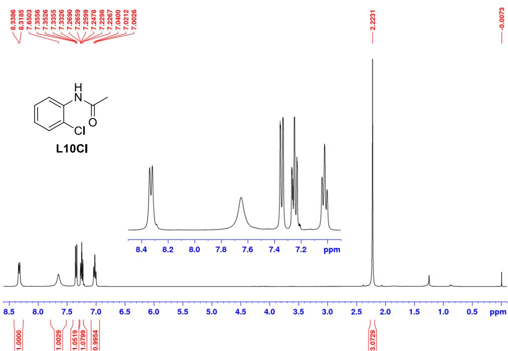
**Slika D186.**  $^1\text{H}$  NMR spektar **L10Cl** u  $\text{CDCl}_3$  (400 MHz).
