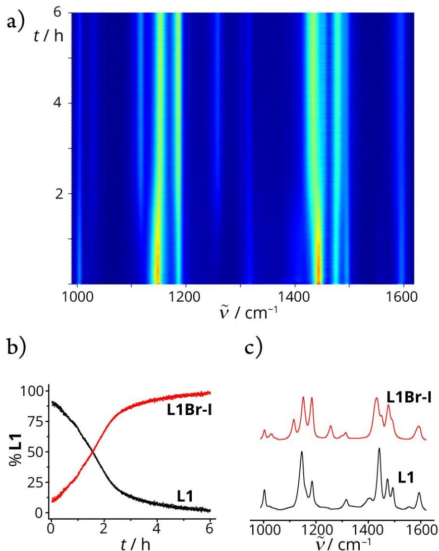
**Slika D10.** a) 2D prikaz vremenski razlučenog Ramanovog praćenja LAG reakcije **L1** (0,5 mmol) s NBS (0,6 mmol), **I1-III** (0,0125 mmol), TsOH $\times$ H<sub>2</sub>O (0,25 mmol), MeCN (15  $\mu$ L) i SiO<sub>2</sub> (250 mg). b) Reakcijski profil dobiven MCR-ALS analizom. c) Ramanovi spektri vrsta opaženih tijekom Ramanovog praćenja reakcije dobiveni MCR-ALS analizom.
