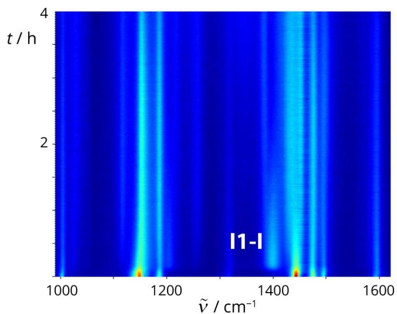
**Slika 51.** 2D prikaz vremenski razlučenog Ramanovog praćenja reakcije **L1** (0,5 mmol), NBS (0,6 mmol), Pd(OAc)<sub>2</sub> (40 mol %, 0,2 mmol), TsOH<sub>x</sub>H<sub>2</sub>O (0,25 mmol), MeCN (15 µL) i SiO<sub>2</sub> (250 mg). *In situ* opažanje paladocikla **I1-I** kao međuproducta halogeniranja **L1** NBS-om kataliziranog s Pd(OAc)<sub>2</sub> u čvrstom stanju.
