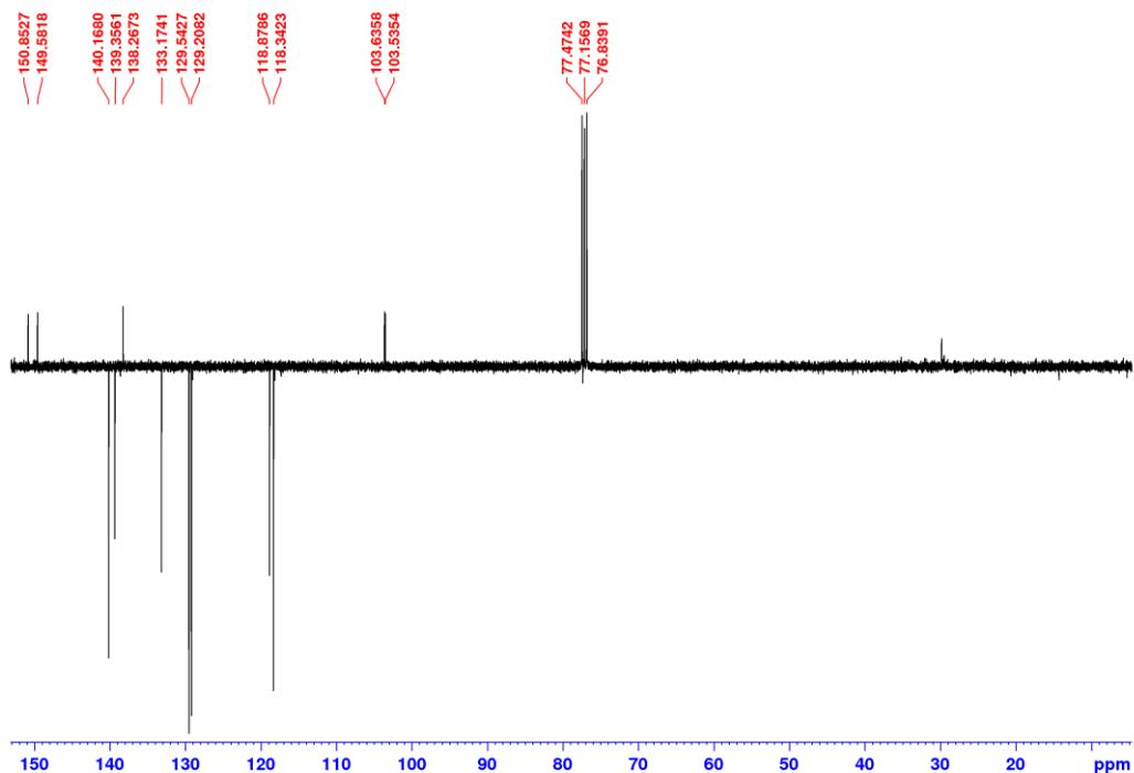
Slika D86.  $^{13}\text{C}$  NMR spektar L2I-II u  $\text{CDCl}_3$  (101 MHz).
