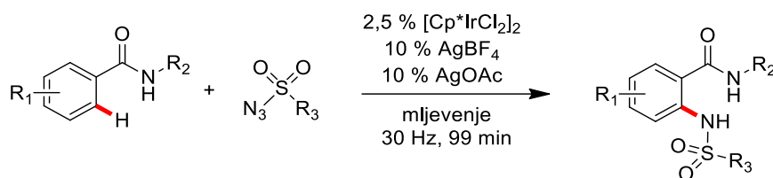
Slika 17. Mehanokemijska amidacija veze C–H uz [\text{Cp}^*\text{IrCl}_2]_2 kao katalizator. 77
