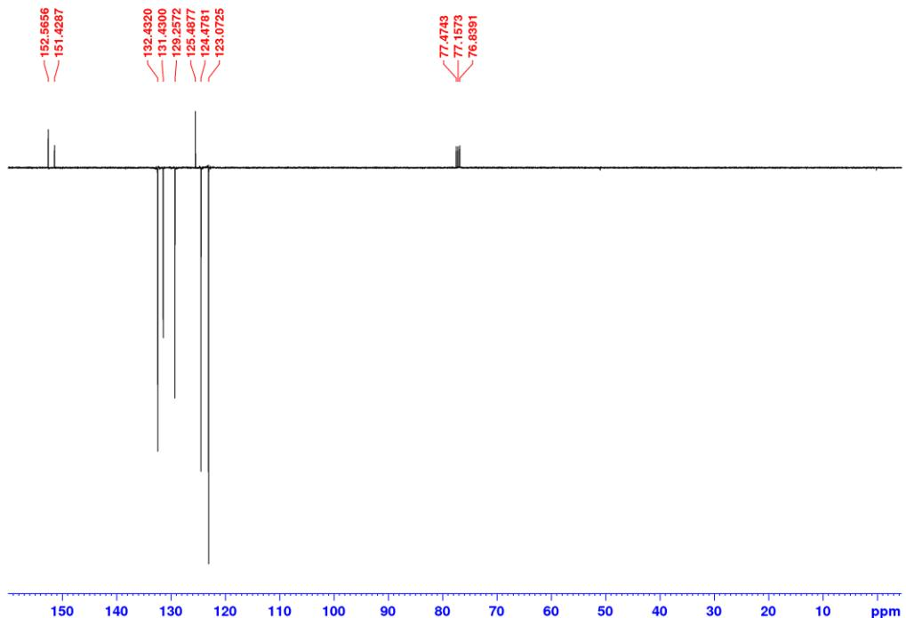
Slika D62.  $^{13}\text{C}$  NMR spektar **L3** u  $\text{CDCl}_3$  (101 MHz).
