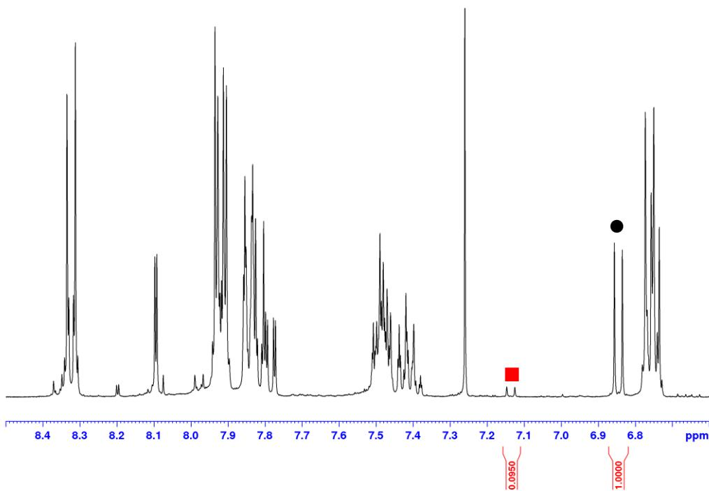
**Slika D52.** Aromatski dio  $^1\text{H}$  NMR spektra sirove reakcijske smjese kompeticijskog eksperimenta između **L6** i **L8** s NBS-om u  $\text{CDCl}_3$  (400 MHz).
