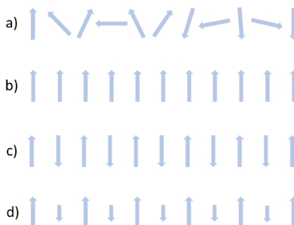
Slika 4. Shematski prikaz magnetskih fenomena u 1D materijalu: a) paramagnetizam, b) feromagnetizam, c) antiferomagnetizam, d) ferimagnetizam
