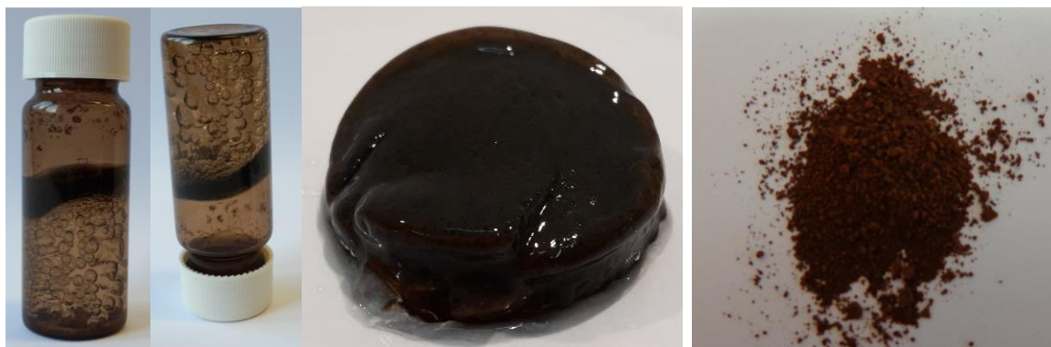
Slika 82. Fotografije magnetičnog nanokompozitnog gela (razdvojene faze) uzorka PVP360-130/9/5/1,85/0,2 (lijevo) i magnetičnog praha PVP40-130/9/5/1,85/0,8 (desno)
