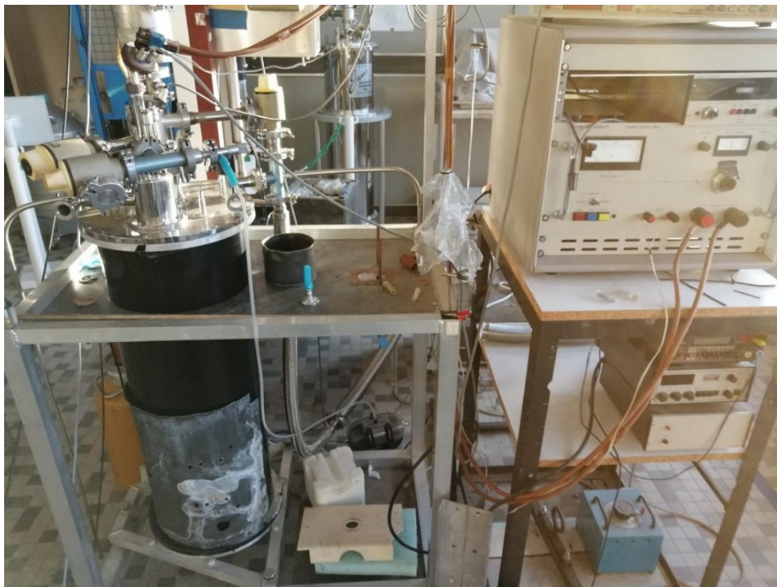
Slika 23. Mössbauerov spektrometar za analizu uzoraka u vanjskom magnetskom polju ( in-field ) na Institut des Molécules et Matériaux (IMMM) u Republici Francuskoj
