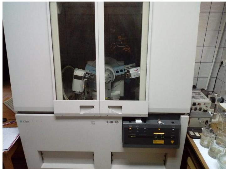
Slika 3.10. Difraktometar Philips PW3040/60 X'Pert Pro korišten za sve rendgenske analize uzoraka iz bušotine B1, prilikom izrade ovog rada
