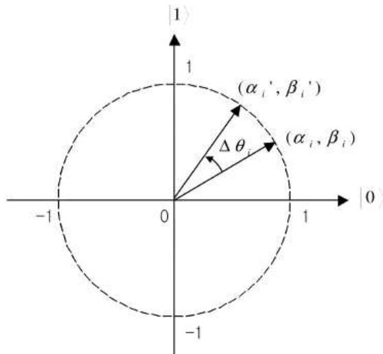
Slika 3.2: Prikaz rotacijskih vrata za kubit pojedinca [6]
