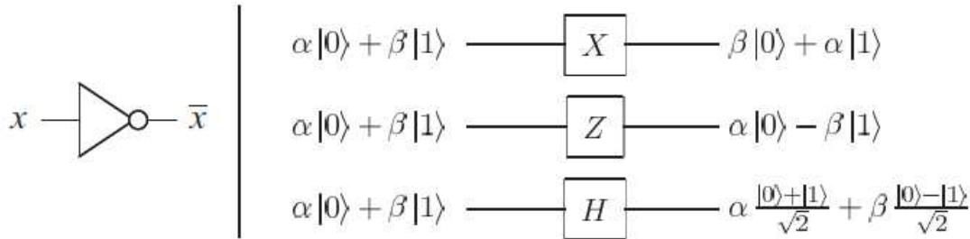
Slika 1.3: Klasična logička vrata i kvantna logička vrata [9]
