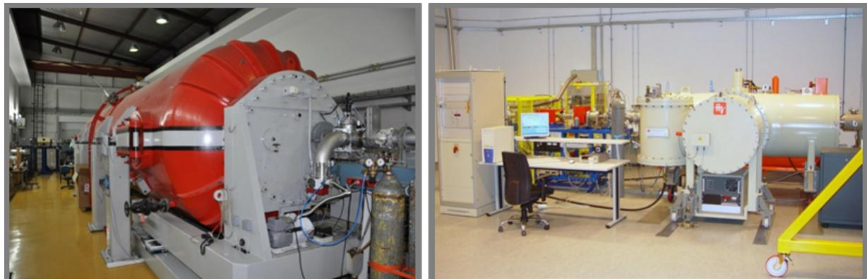
Slika 3.4: 6.0 MV EN Tandem Van de Graaff (lijevo) i 1.0 MV Tandetron (desno) [13].
