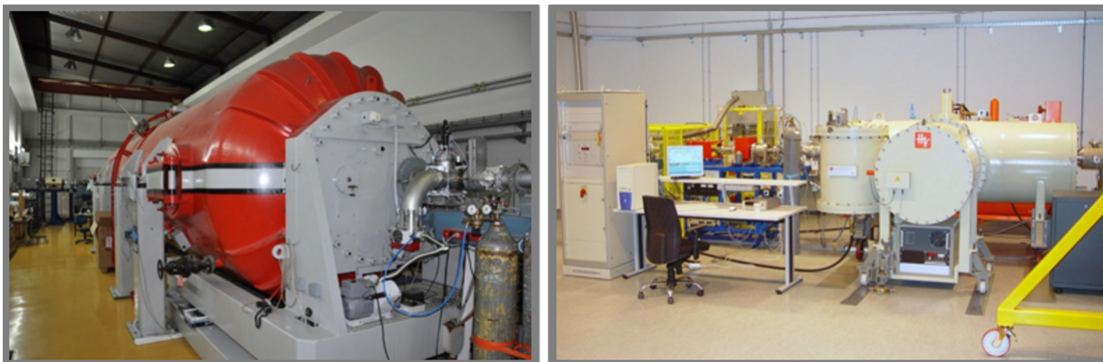
Slika 3.4: 6.0 MV EN Tandem Van de Graaff (lijevo) i 1.0 MV Tandetron (desno) [13].
