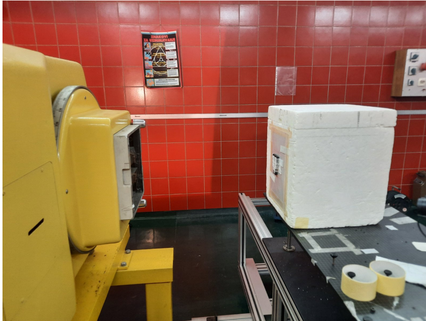
Slika 3.7: Izvor \gamma -zračenja korišten u radu je nekadašnji teleterapijski uređaj (ALCYON II, tip izvora COT 20, serijski broj 3507, proizvođača ORIS /CGR MeV/). Desno od izvora se vide dozimetri pričvršćeni na kocku od stiropora.
