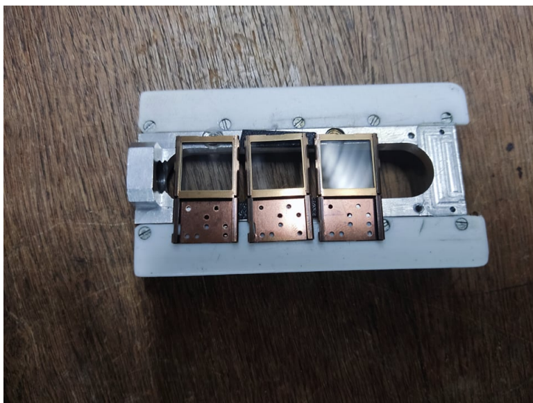
Slika 3.6: Držač u staroj mikroprobi. Prikazano je postavljanje dozimetara i prazno mjesto pored njih koje je služilo mjerenju toka snopa.
