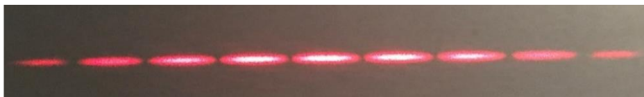
Slika 1. Slika dobivena na zastoru pomoću dviju uskih pukotina i monokromatske svjetlosti [69].
