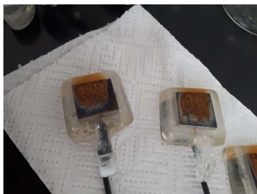
Slika 1. Izgled uzorak ugljičnog čelika prije ispitivanja
