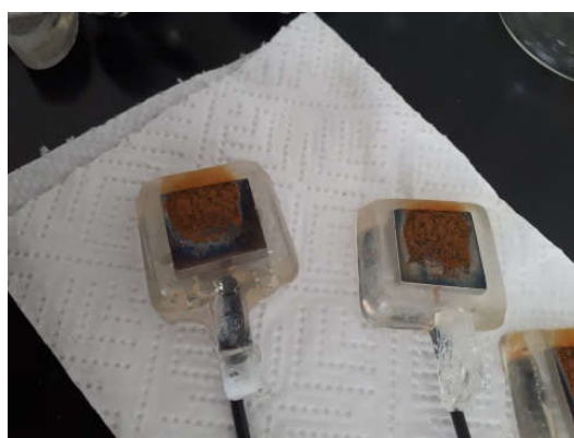
Slika 1. Izgled uzorak ugljičnog čelika prije ispitivanja
