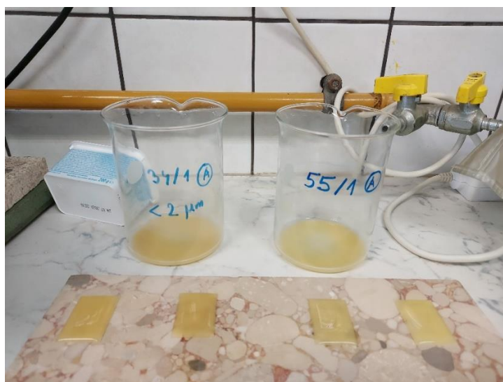
Slika 19. Suspenzija čestica manjih od 2\ \mu\text{m} koje su nakapavane na predmetno stakalce te sušeni na sobnoj temperaturi
