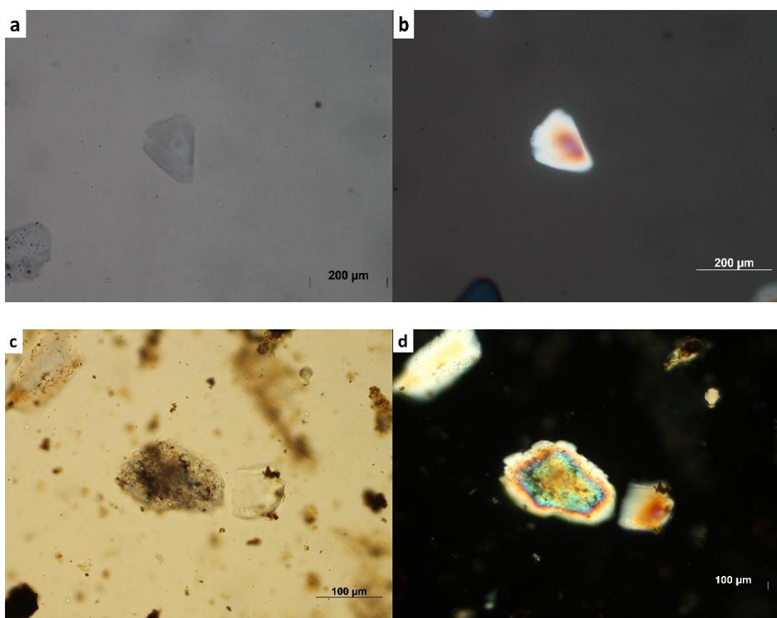
Slika 25. Fotografije mineralnih zrna iz uzorka tufova: a, b – kremen (34/1); c, d – feldspat
