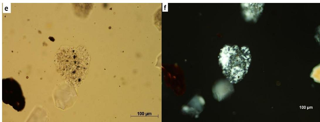
Slika 24. (nastavak) Fotografije mineralnih zrna iz uzorka tufova: e, f – devitrificirano staklo
