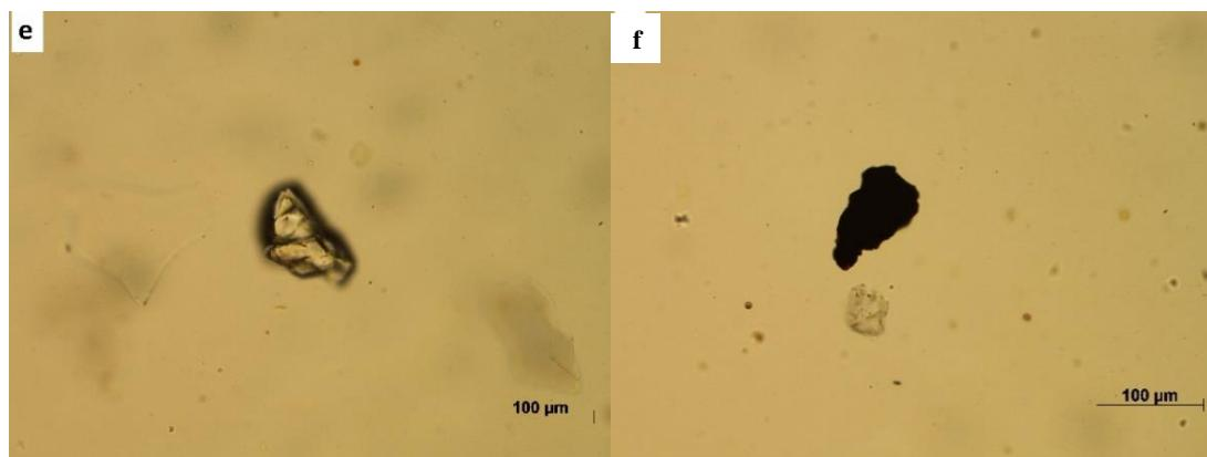
Slika 27. (nastavak) Fotografije mineralnih zrna iz uzorka tufova: e – granat (34/1); f – opäki minerali (77/1)
