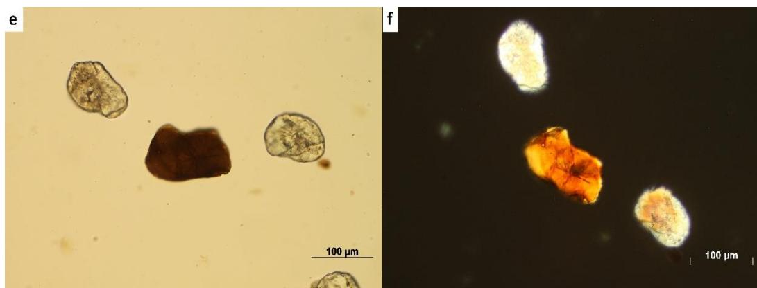
Slika 26. (nastavak) Fotografije mineralnih zrna iz uzorka tufova: e, f – biotit (34/1)
