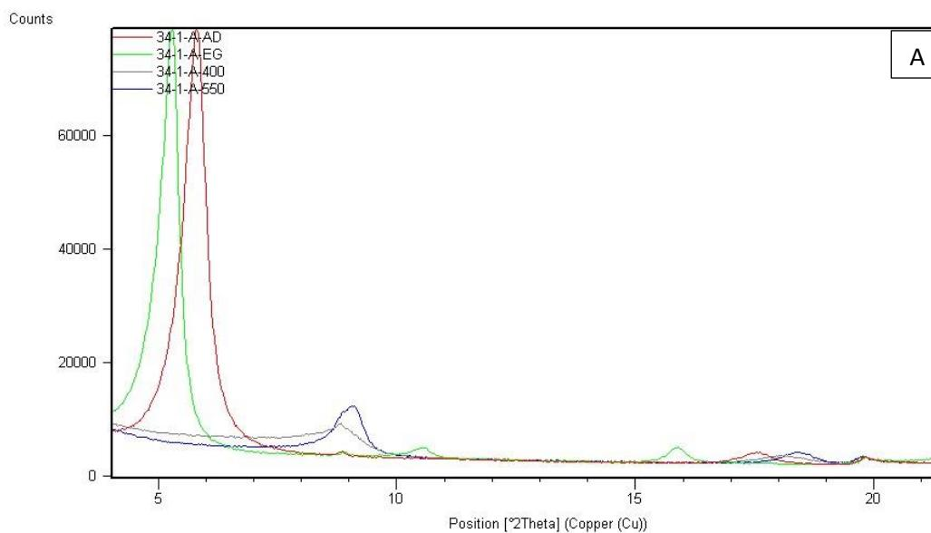
Slika 29. Prikaz difraktograma uzorka tufova. A) Uzorak 34/1. Oznake vrijede za sva tri uzroka: A-AD – netretirani preparat; A-EG – preparat tretiran etilen glikolom; A-400 – preparat žaren na  $400^\circ\text{C}$  i A-550 – preparat žaren na  $550^\circ\text{C}$ .
