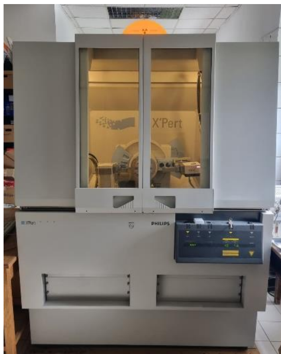
Slika 18. Difraktometar Philips X-pert PRO korišten pri analizi uzoraka
