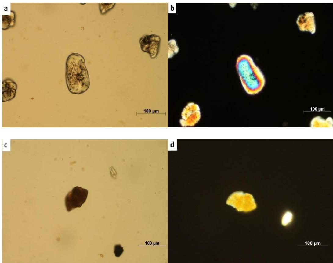
Slika 27. Fotografije mineralnih zrna iz uzorka tufova: a, b – barit (34/1); c, d – jarosit (55/1)
