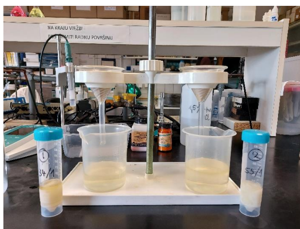
Slika 15. Aparatura za filtriranje
