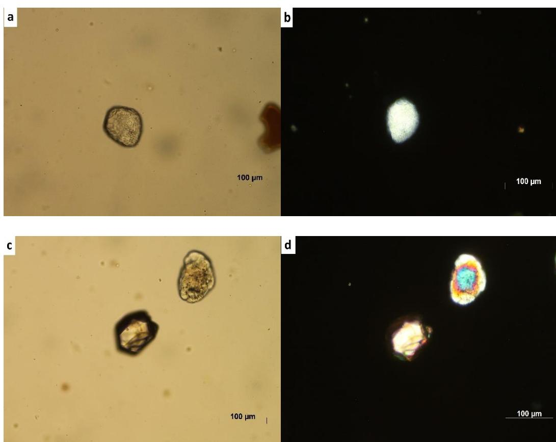
Slika 26. Fotografije mineralnih zrna iz uzorka tufova: a, b – apatit (77/1); c, d – cirkon (34/1)
