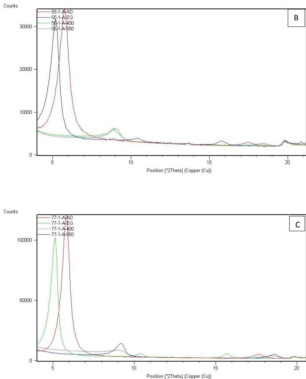
Slika 29. (nastavak) Prikaz difraktograma uzorka tufova. B) Uzorak 55/1; C) Uzorak 77/1. Oznake vrijede za sva tri uzroka: A-AD – netretirani preparat; A-EG – preparat tretiran etilen glikolom; A-400 – preparat žaren na 400°C i A-550 – preparat žaren na 550°C.
