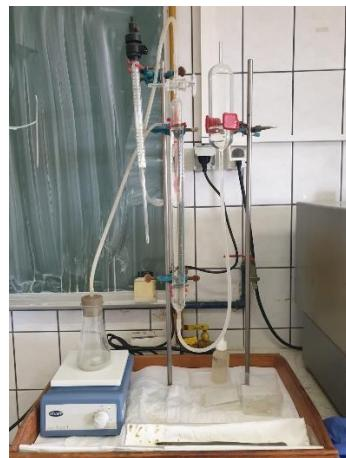
Slika 11. Aparatura za određivanje karbonatne komponente
