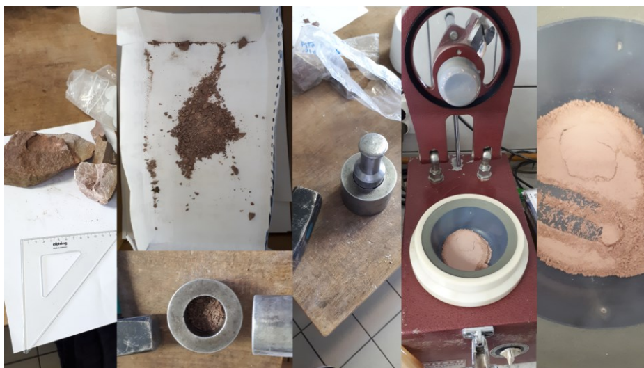
Slika 7. Slijed usitnjavanja uzorka
