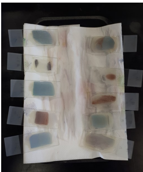
Slika 9. Mikroskopski preparati nakon metode bojanja karbonata
