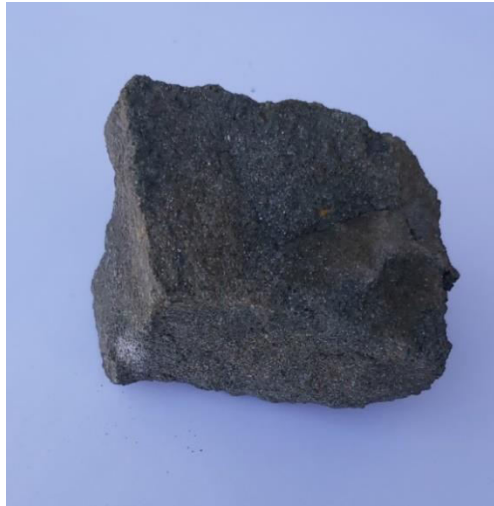
Slika 5. Makroskopski uzorak analiziranog pješčenjaka. Širina fotografije je 12 cm.
