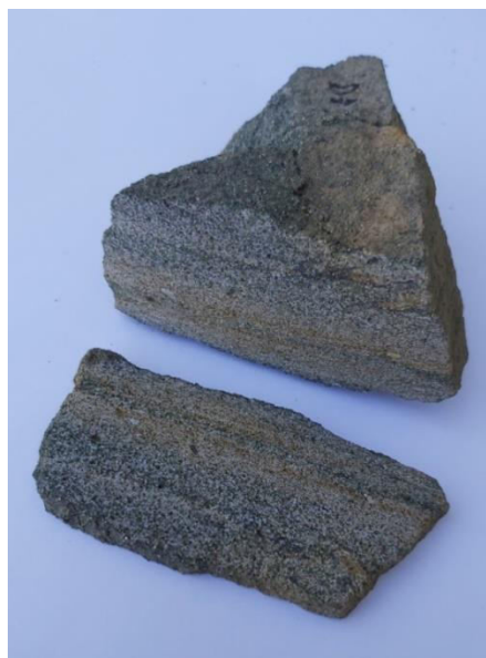
Slika 6. Uzorak pješčenjaka rezan pilom. Širina fotografije je 12 cm.
