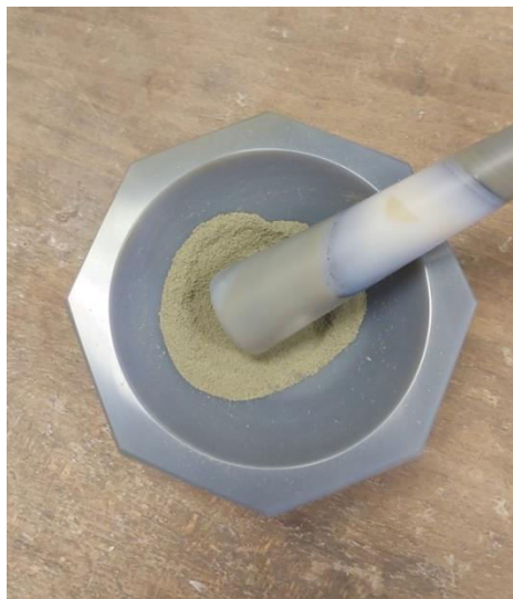
Slika 9. Mrvljenje uzorka pješčenjaka u ahatnom tarioniku. Širina fotografije je 15 cm.
