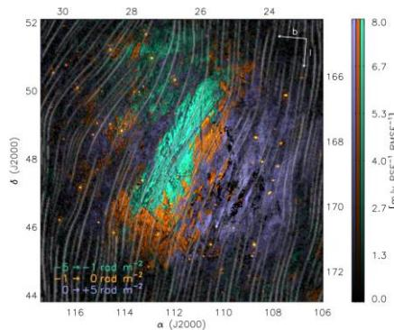
**Slika 1.** Slika prikazuje morfologiju polariziranog sinkrotronskog zračenja naše galaksije detektirane na niskim radiofrekvencijama pomoću radioteleskopa LOFAR. Slika obuhvaća oko 70 kvadratnih stupnjeva neba u području zviježđa Risa. Za usporedbu, puni Mjesec na nebu zauzima oko 0.2 kvadratna stupnja. Različite boje ilustriraju količinu rotacije polariziranog kuta sinkrotronskog zračenja (Faradayeva rotacija) koju je uzrokovala ionizirana međuvjezdana materija duž doglednice.
