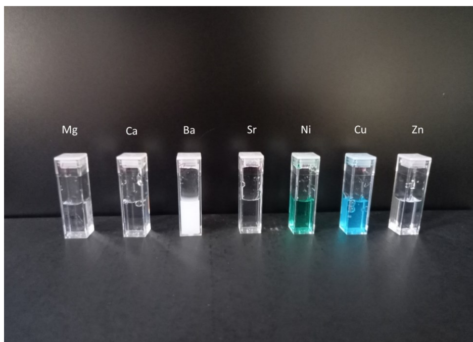
Slika 18. Otopine poli(natrijevog 4-stirensulfonata) ( c = 0,01 \text{ mol dm}^{-3} ) s različitim dvovalentnim kationima ( c = 0,5 \text{ mol dm}^{-3} ) pri \text{pH} = 4,0 .
