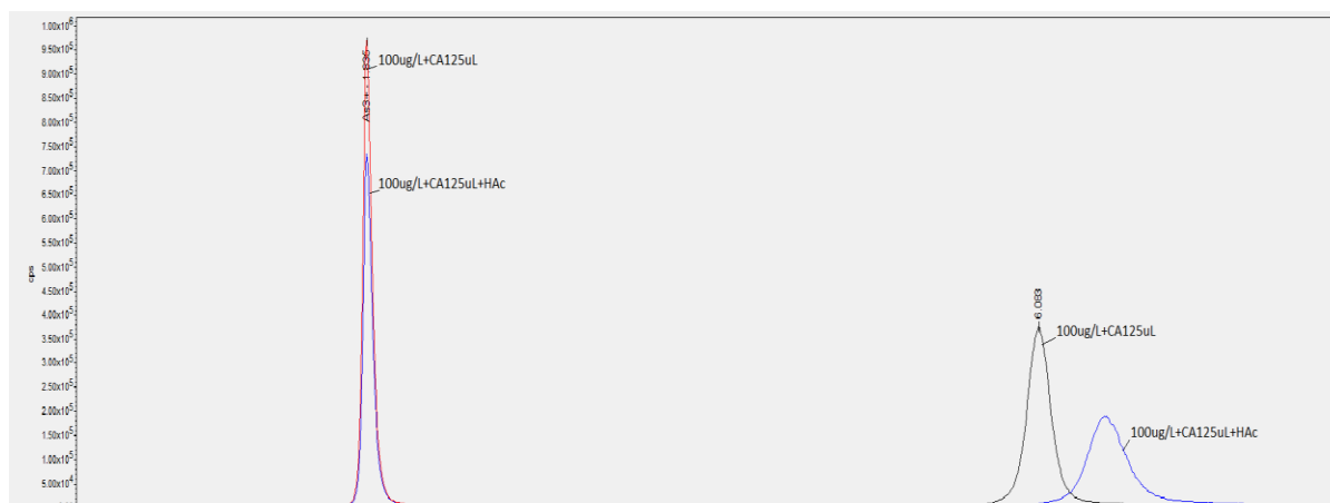
Dodatak 14. Kromatogram otopine As(III)/As(V) koncentracije 100 \mu\text{g L}^{-1} s dodatkom CA (citratne kiseline) 125 \mu\text{L} ( 2.5 \text{ mM} u ukupnom volumenu) i s dodatkom HAc (1 % u ukupnom volumenu) nakon 2 sta.
