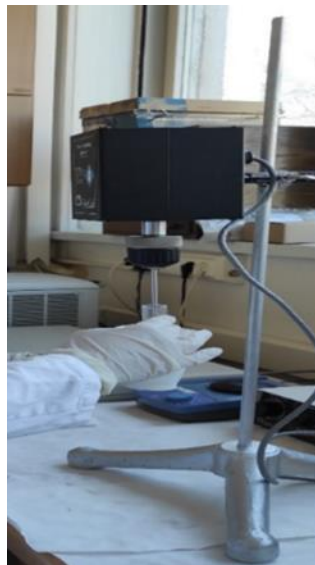
Slika 7. Homogeniziranje mišićnog tkiva pomoću homogenizatora s teflonskim batićem. (Autor fotografije: Zoran Kiralj).
