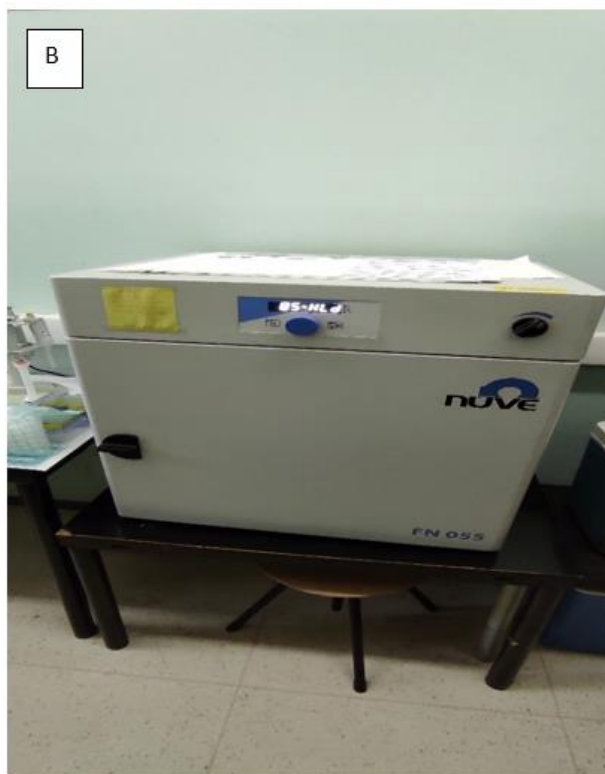
Slika 8. Razgradnja mišića štuke za potrebe analize metala, dodavanje kiseline (A) (Autor fotografije: Tatjana Mijošek) i grijanje u sušioniku (B).
