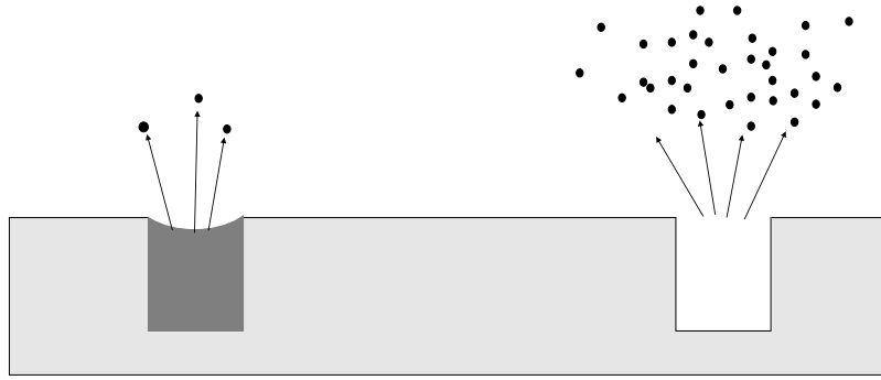
Slika 2.4: Shematski prikaz dva mehanizma toplinske desorpcije. Lijevo je prikazana aktivirana desorpcija, tj. isparavanje. Desno je prikazana desorpcija komada materijala poslije nepovratnog prijelaza u plinovitu fazu. Slika je reproducirana iz [52].
