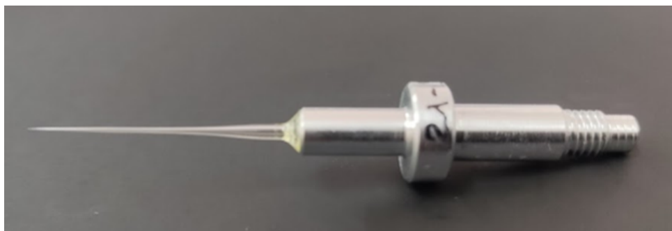
Slika 3.2: Fotografija jedne od korištenih staklenih kapilara. Konusne kapilare napravljene su u ETH-u u Švicarskoj i postavljene na metalni nosač.
