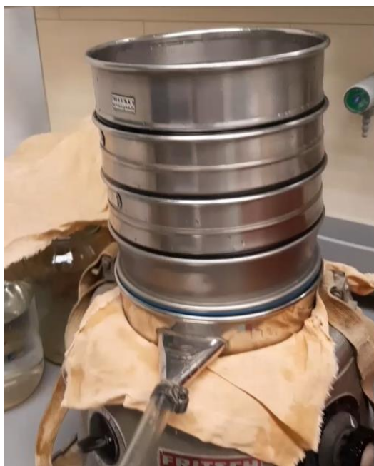
Slika 4 - Set sita na tresilici
