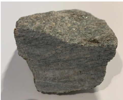
Slika 3. Uzorak 1 svjetla metamorfna stijena sa vidljivom žilom kvarca
