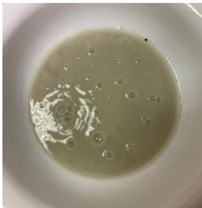
Slika 7. Slaba reakcija uzorka s 30% otopinom vodikovog peroksida.
