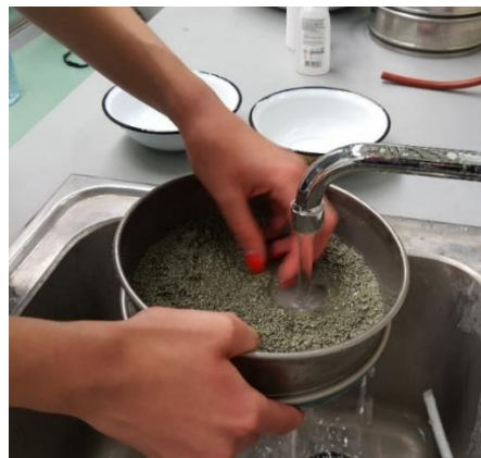
Slika 8. Ispiranje i prosijavanje uzorka na situ promjera rupica 63 \mu\text{m} .
