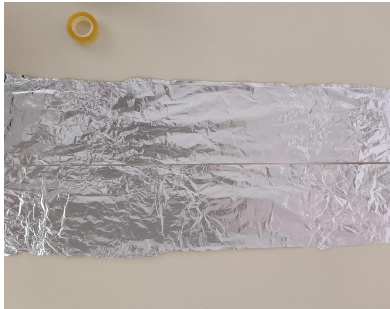
Slika 4.5 Razmaknute vodljive vrpce vremenskih vrata
