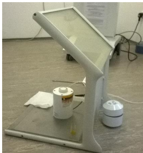
Slika 11. Ionizacijska komora iza zaštitnog olovnog L bloka [27].
