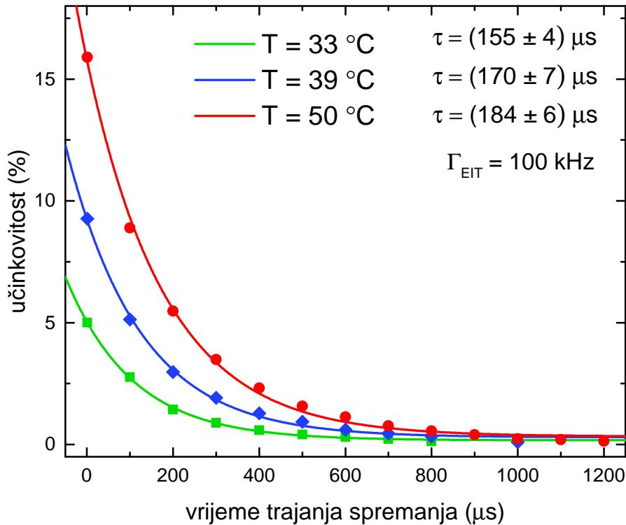
Slika 4.10: Graf ovisnosti učinkovitosti kvantne memorije o vremenu spremanja za različite temperature čelije s parafinom i inertnim plinom na frekvenciji koja je odmaknuta 580 MHz od prijelaza. Vremena života memorije za svaku temperaturu nalaze se u gornjem desnom kutu. Kvantna memorija pokazuje značajno bolja svojstva za više temperature.
