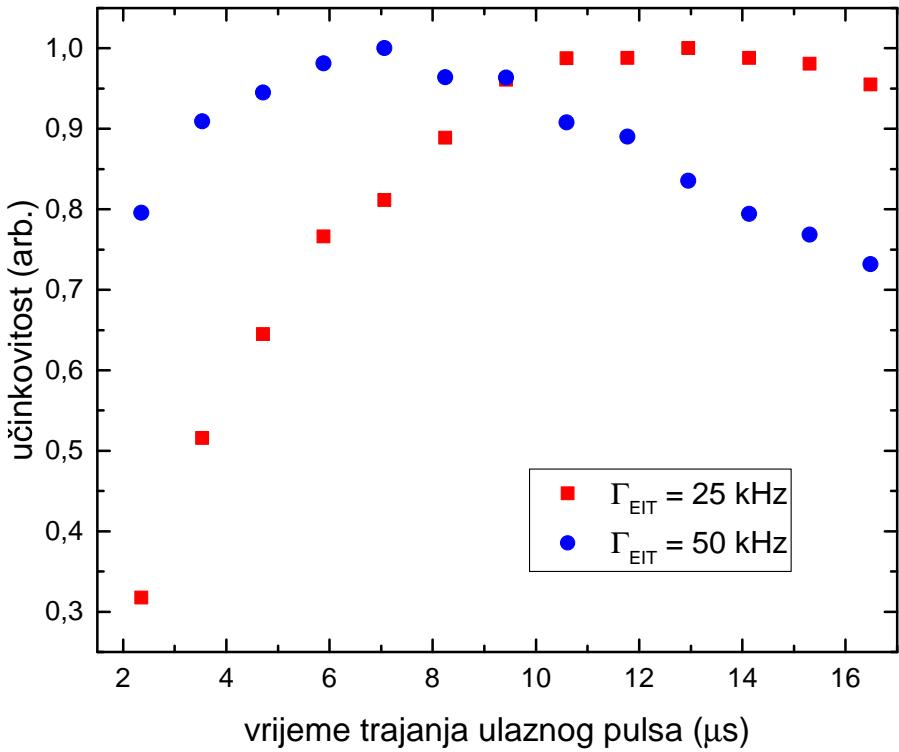
Slika 4.6: Usporedba učinkovitosti kvantne memorije za različita vremena trajanja ulaznog pulsa za širine EIT rezonancije od 25 i 50 kHz u čeliji s parafinom i inertnim plinom. Možemo primjetiti da je vrijeme trajanja ulaznog pulsa za maksimalnu vrijednost učinkovitosti na širini EIT rezonancije od 25 kHz dvostruko veća od one za širinu EIT rezonancije od 50 kHz.
