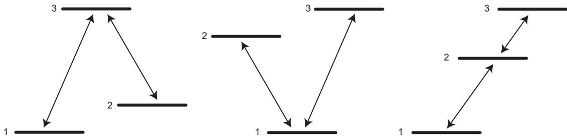
Slika 2.1: Konfiguracije sustava energijskih razina atoma u kojima je demonstriran EIT. Slijeva nadesno: lambda-stanje, V-stanje, stanje oblika ljestvi. Svjetlosti jedne frekvencije možemo pobuditi prijelaz između neka dva energijska stanja i zasiliti pobuđeno energijsko stanje. Ukoliko svjetlost druge frekvencije odgovara prijelazu iz nekog drugog energijskog stanja u sada ispunjeno stanje, neće doći do apsorpcije te svjetlosti.
