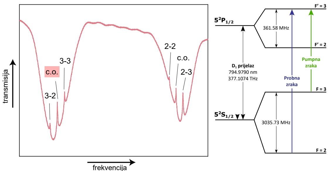
Slika 3.5: Izgled rubidijevog spektra dobiven saturacijskom spektroskopijom (lijevo) uz shemu energijskih razina na D1 prijelazu u atomu  $^{85}\text{Rb}$ . Točka stabilizacije (tekst u bijedom crvenom) nalazi se na crossoveru između prijelaza hiperfinih nivoa  $|F\rangle = 3 \rightarrow |F'\rangle = 2$  i  $|F\rangle = 3 \rightarrow |F'\rangle = 3$  unutar D1 prijelaza u  $^{85}\text{Rb}$ .
