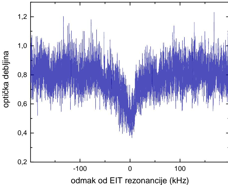
Slika 4.3: EIT na čeliji premazanoj alkenom za niske snage pumpne zrake. Uočljiva je visoka razina šuma koje otežava precizno određivanje širine EIT rezonancije.
