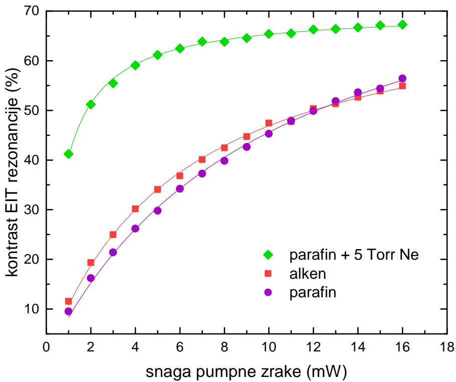
Slika 4.4: Kontrasti na različitim snagama pumpne zrake za tri različite ćelije na sobnoj temperaturi  $T = 22^\circ\text{C}$ . Daleko najbolji kontrast nalazimo kod ćelije s parafinom i inertnim plinom, dok kod druge dvije ćelije imamo slabiji kontrast.
