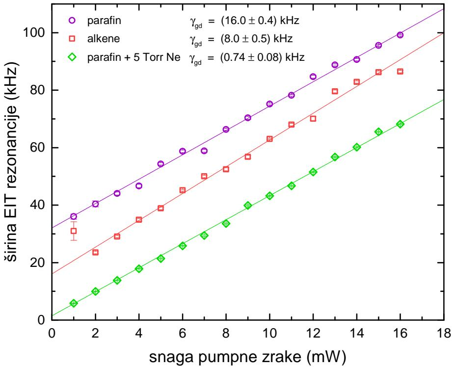
Slika 4.2: Ovisnost širine EIT rezonancije o snazi pumpne zrake za tri različite ćelije na sobnoj temperaturi  $T=22\text{ }^{\circ}\text{C}$ . Linije na slici predstavljaju prilagodbu linearne funkcije na izmjerene vrijednosti za svaku ćeliju. Vrijednosti linearnih frekvencija izmjerena dekoherenčija izvedene su iz odsječaka svakog od prilagođenih pravaca te su zapisane na gornjem rubu grafa.
