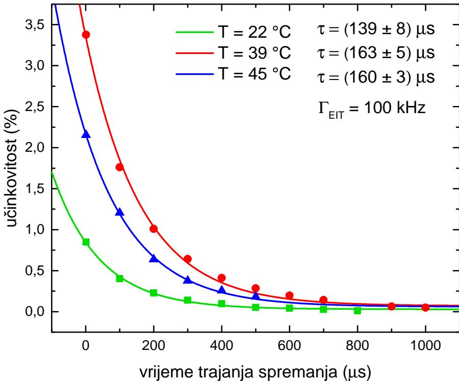
Slika 4.9: Graf ovisnosti učinkovitosti kvantne memorije o vremenu spremanja za različite temperature čelije s parafinom i inertnim plinom na frekvenciji prijelaza. Vremena života memorije za svaku temperaturu nalaze se u gornjem desnom kutu. Najbolja svojstva dobivamo za temperaturu  $39\text{ }^{\circ}\text{C}$ , gdje postižemo vremena spremanja od 1 ms.
