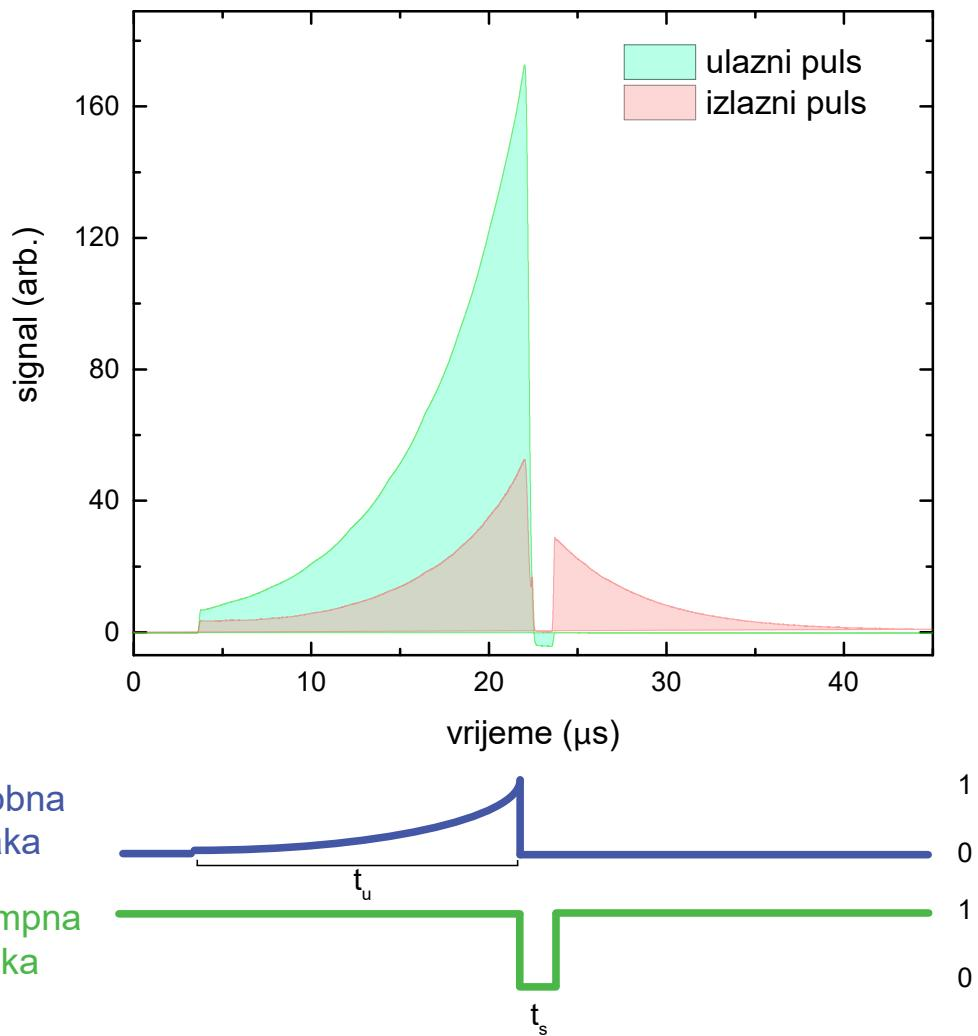
Slika 4.5: Primjer izgleda izmjerenih signala kvantne memorije za ulazni i izlazni puls zajedno s pripadnim protokolom kvantne memorije. Probnu zraku upalimo u vremenu trajanja  $t_u$  i skaliramo joj snagu eksponencijalno, nakon čega odmah gasimo prije upaljenu pumpu za vrijeme trajanja spremanja  $t_s$ . Izlazni puls ispušten prije gašenja pumpne zrake odgovara dijelu pulsa koji nije zadržan unutar atomskog medija.
