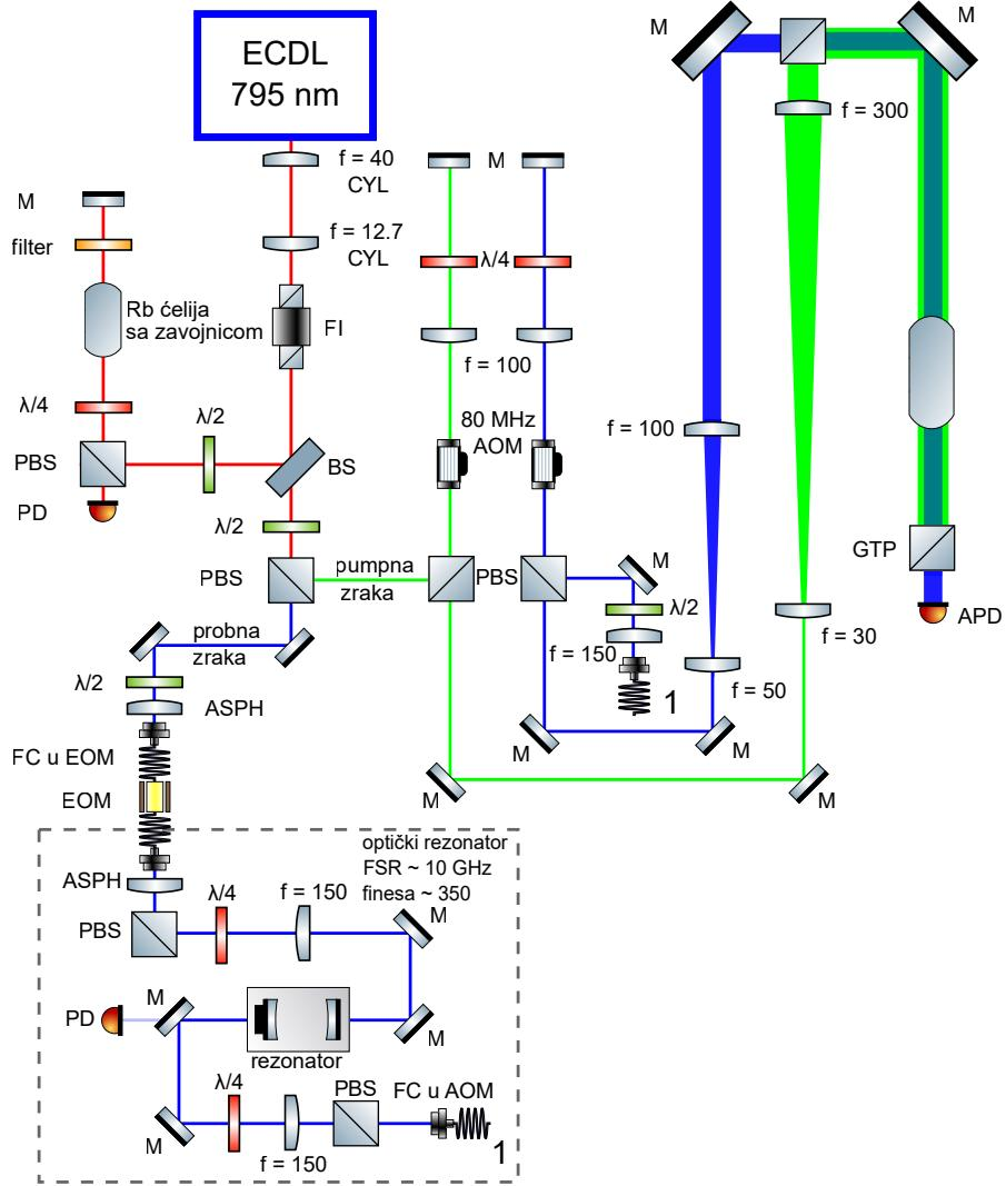
Slika 3.2: Shema eksperimentalnog postava. CYL - cilindrična leća, FI - Faradayev izolator, BS - djelitelj zraka, PBS - polarizacijska kocka, PD - fotodioda, FC - vezanje u optičko vlakno, ASPH - asferična leća, EOM - elektro-optički modulator, AOM - akusto-optički modulator, GTP - Glan-Thompsonov polarizator.
