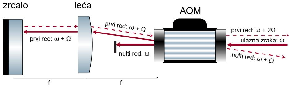
Slika 3.10: Postav dvostrukog prolaza laserske zrake kroz AOM. Originalna frekvencija označena je slovom  $\omega$ , a frekvencija dodana AOM-om slovom  $\Omega$ . Leća je postavljena tako da su joj i AOM i zrcalo u fokusu, što omogućuje izdvajanje zrake frekvencije  $\omega + 2\Omega$ . Prilagođeno iz [20].
