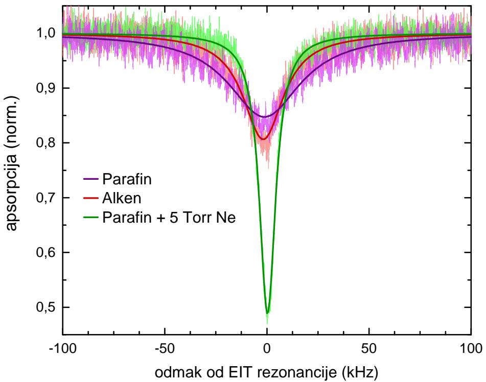
Slika 4.1: Apsorpcijski spektar EIT-a triju mjereneh čelija za istu snagu pumpne zrake na sobnoj temperaturi. Jasno je vidljivo da je najuža EIT rezonancija ona mjerena na čeliji koja sadrži neon i parafinski premaz. Čelije iznutra premazane parafinom i alkenom su sličnije, ali je očito da čelija premazana alkenom ima užu rezonanciju EIT-a.
