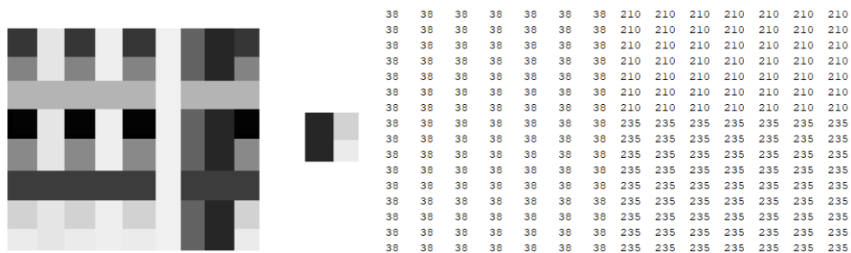
Slika 3.2: Slika u sivim tonovima (lijevo) s izrezanim dijelom slike (sredina) i matricnim prikazom vrijednosti piksela izrezanog dijela slike (desno)
