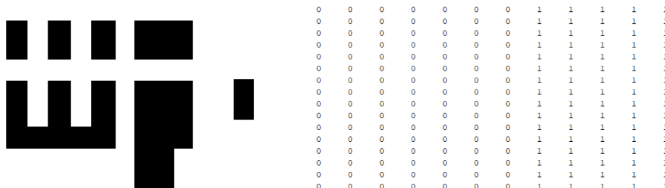
Slika 3.3: Slika dobivena obradom slike 3.3 i izrezanim dijelom binarne slike (sredina) te matričnim prikazom vrijednosti piksela izrezanog dijela binarne slike
