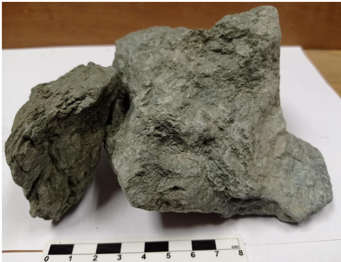
Slika 22. Uzorak Bz5 vidljiva je škrljavost (lijevo) i kompaktnost (desno).
