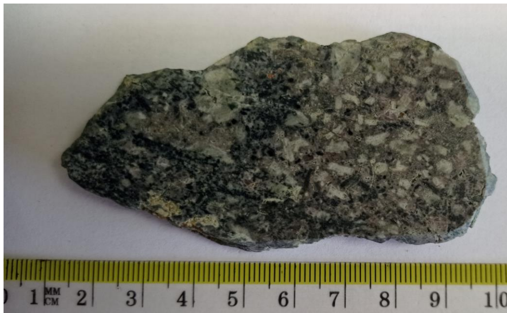
Slika 26. Uzorak Bz10 vidljive afanitske strukture.
