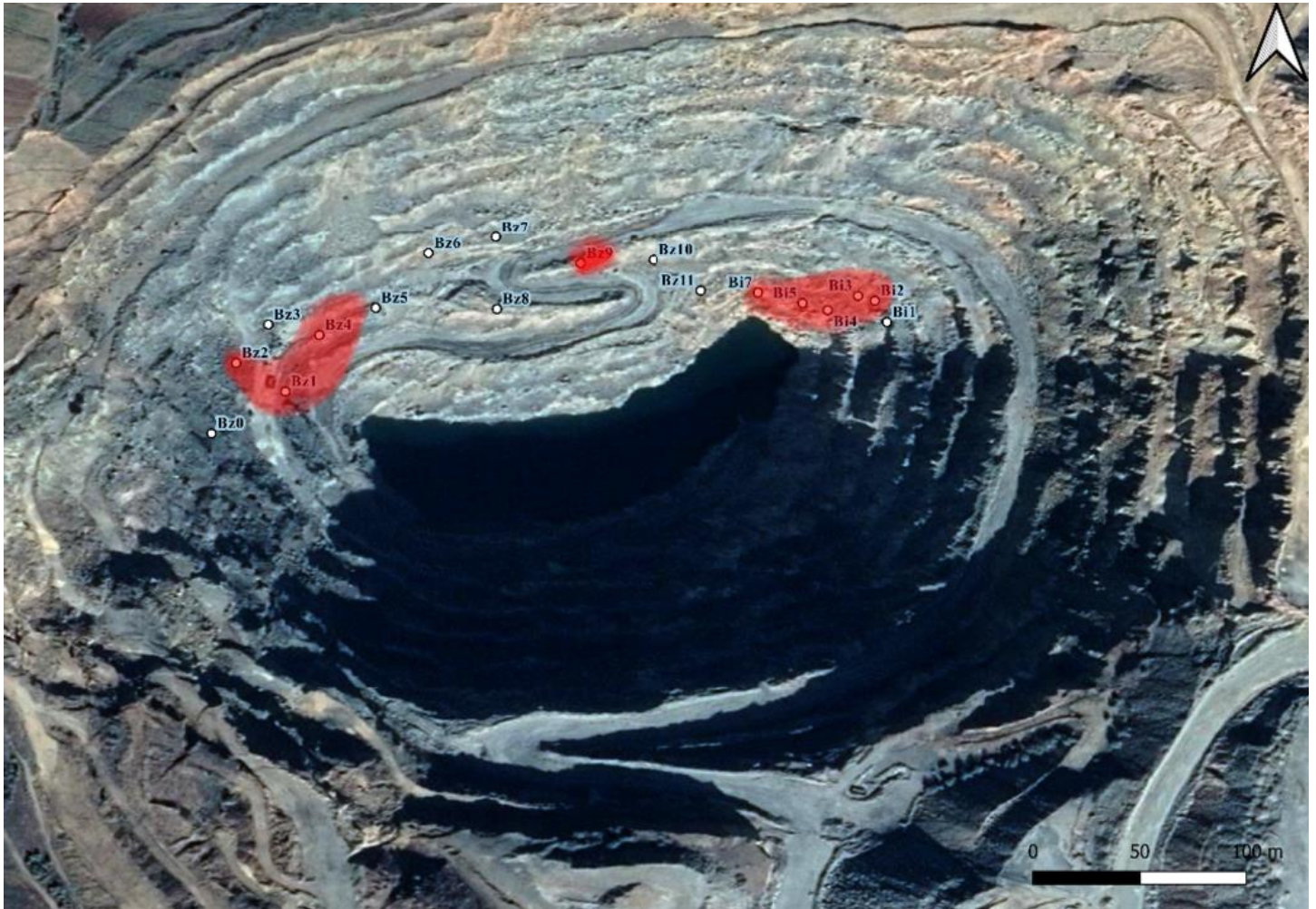
Slika 61. Na slici je prikazana sericitna alteracijska zona označena crvenom bojom.
