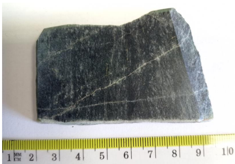
Slika 17. Uzorak Bz0 prikazuje škriljavu teksturu i dominaciju mafične faze
