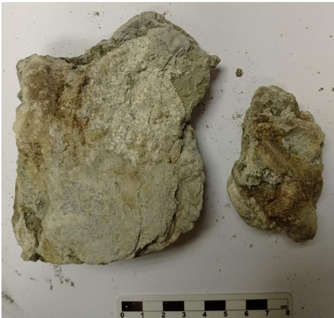
Slika 15. Uzorak Bi5 alterirani andezit
