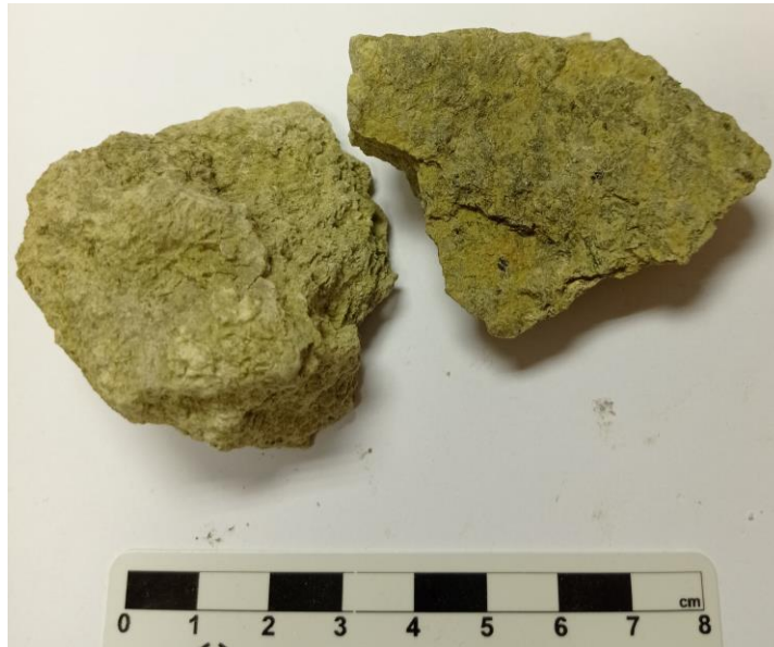
Slika 16. Uzorak Bi7 na slici desno vidljiv mastan sjaj i uklopak biotita.
