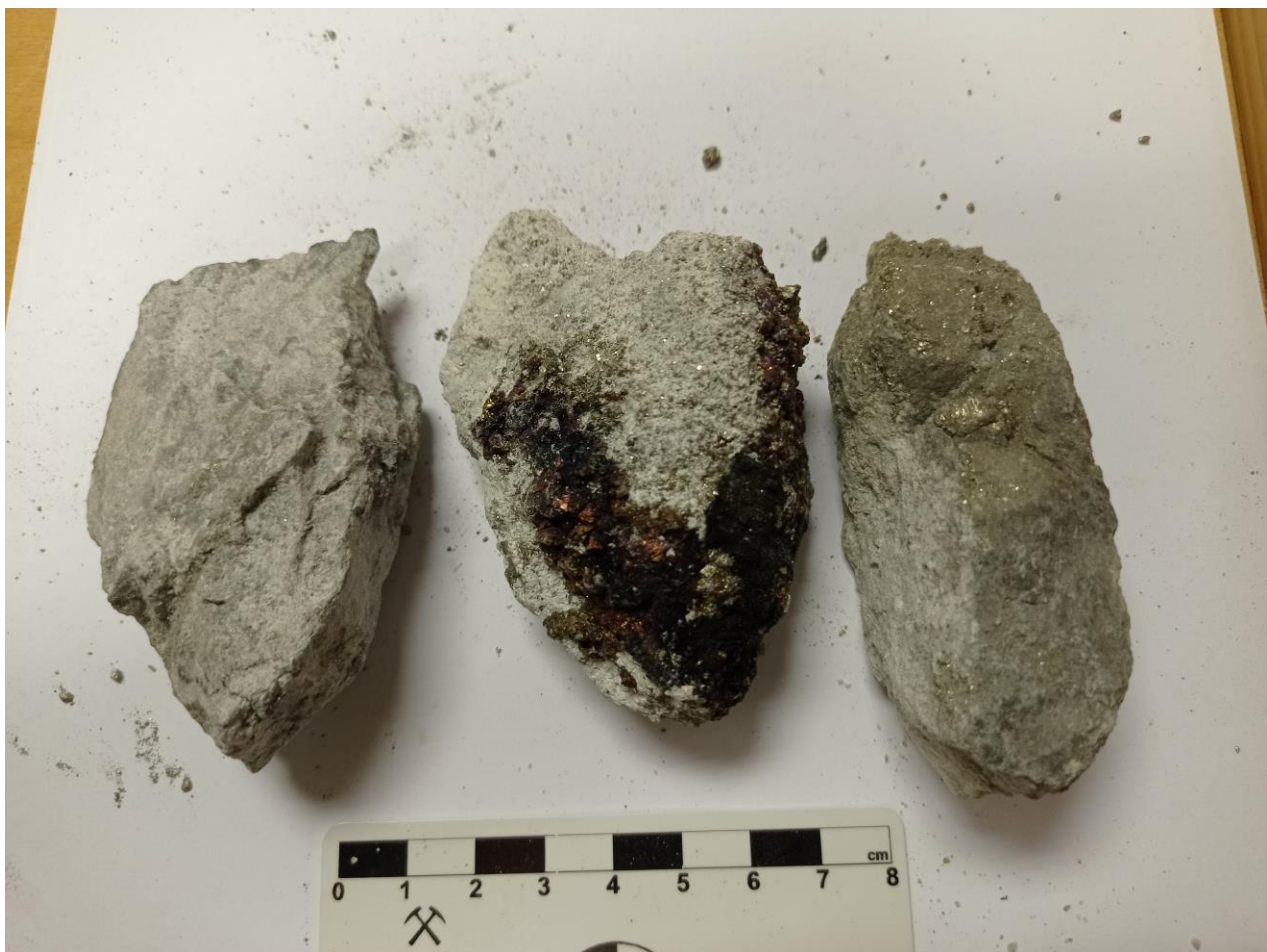
Slika 12. Na uzorku Bi2 lijeva stijena prikazuje diseminirani pirit u sivoj fazi, na srednjoj stijeni iritizaciju pirita i bornit, a na desnoj mineralizaciju pirita.
