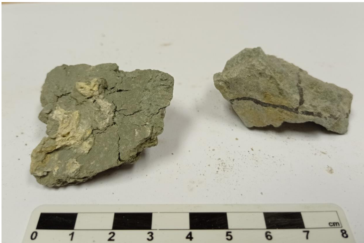
Slika 19. Uzorak Bz2 ima koričastu sivu fazu (lijevo), a lijevo je kompaktni primjer andezita sa iste točke.
