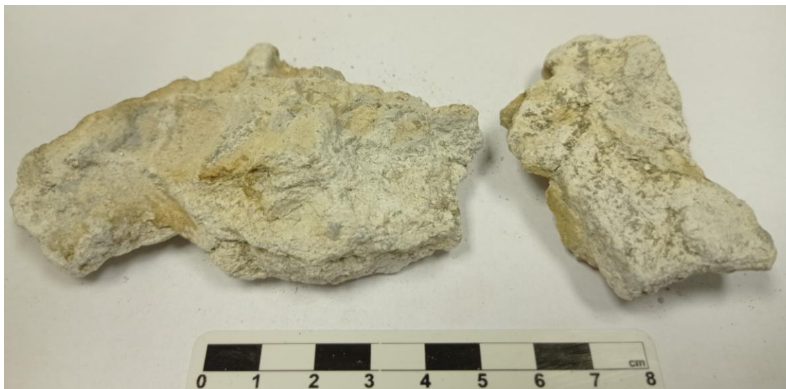
Slika 20. Uzorak Bz3 prikazuje bijelu praškastu fazu i mineralizaciju pirita (lijevo i desno).
