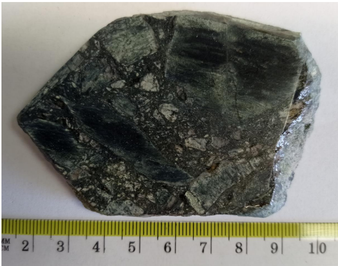
Slika 24. Uzorak Bz8 andezita porfirne strukture.
