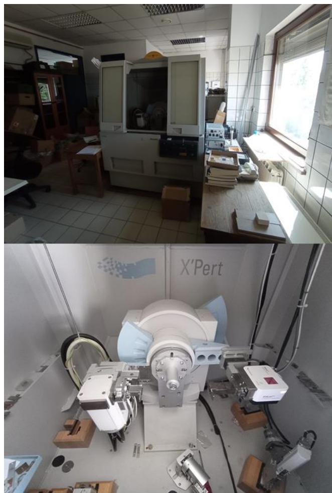
Slika 7. XRD instrument korišten za kvalitativnu analizu uzorka u prahu.
