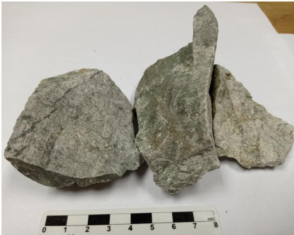
Slika 23. Uzorak je slabo izmijenjeni andezit sa vidljivom površinskom mineralizacijom u obliku korice (srednji fragment).
