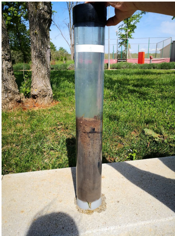
Slika 10: Priprema uzoraka, prikupljanje sedimenta pomoću plastičnog korera.
