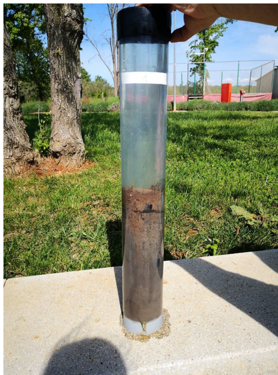
Slika 10: Priprema uzoraka, prikupljanje sedimenta pomoću plastičnog korera.
