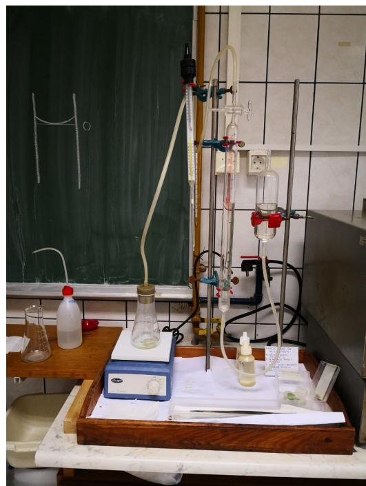
Slika 17: Scheiblerova aparatura za kalcimetriju, Mineraloško-petrografski zavod PMF-a.
