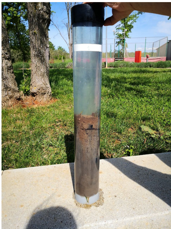
Slika 10: Priprema uzoraka, prikupljanje sedimenta pomoću plastičnog korera.
