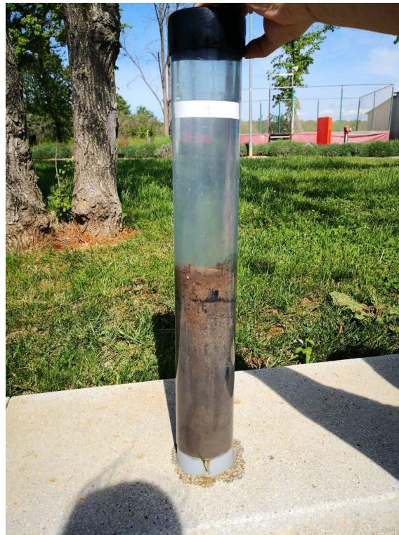
Slika 10: Priprema uzorka, prikupljanje sedimenta pomoću plastičnog korera.
