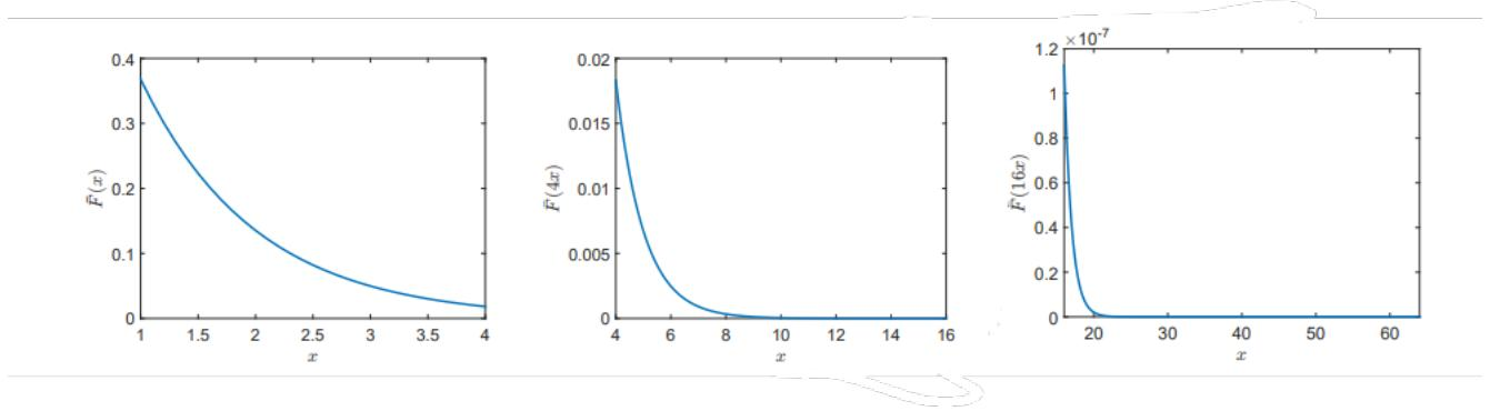
Slika 2.1: Eksponencijalna distribucija (s parametrom  $\mu = 1$ ) nije asimptotski invarijantna na skaliranje jer krivulja izgleda potpuno različito na više skala
