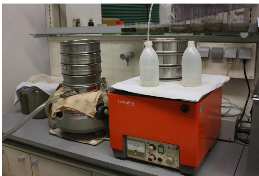
Slika 7. Sustav sita tijekom mokrog sisanja
