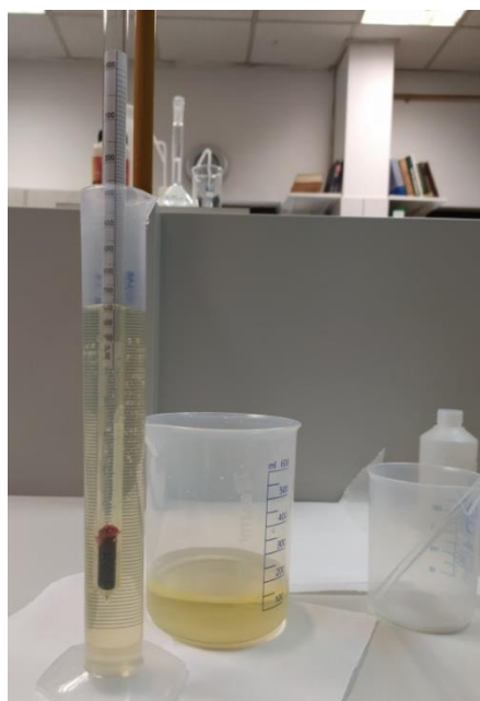
Slika 12. Mjerenje gustoće otopine areometrom
