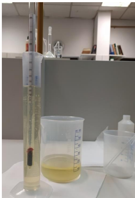
Slika 12. Mjerenje gustoće otopine areometrom
