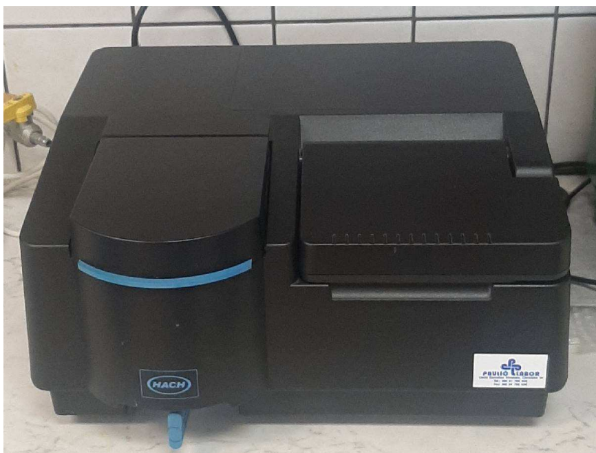
Slika 22. Spektrofotometar HACH DR/4000.
