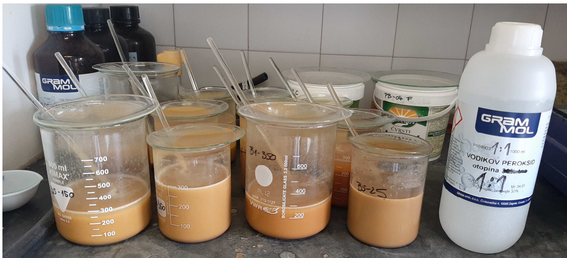
Slika 21. Uklanjanje organske tvari dodatkom 15%-tnog vodikovog peroksida.
