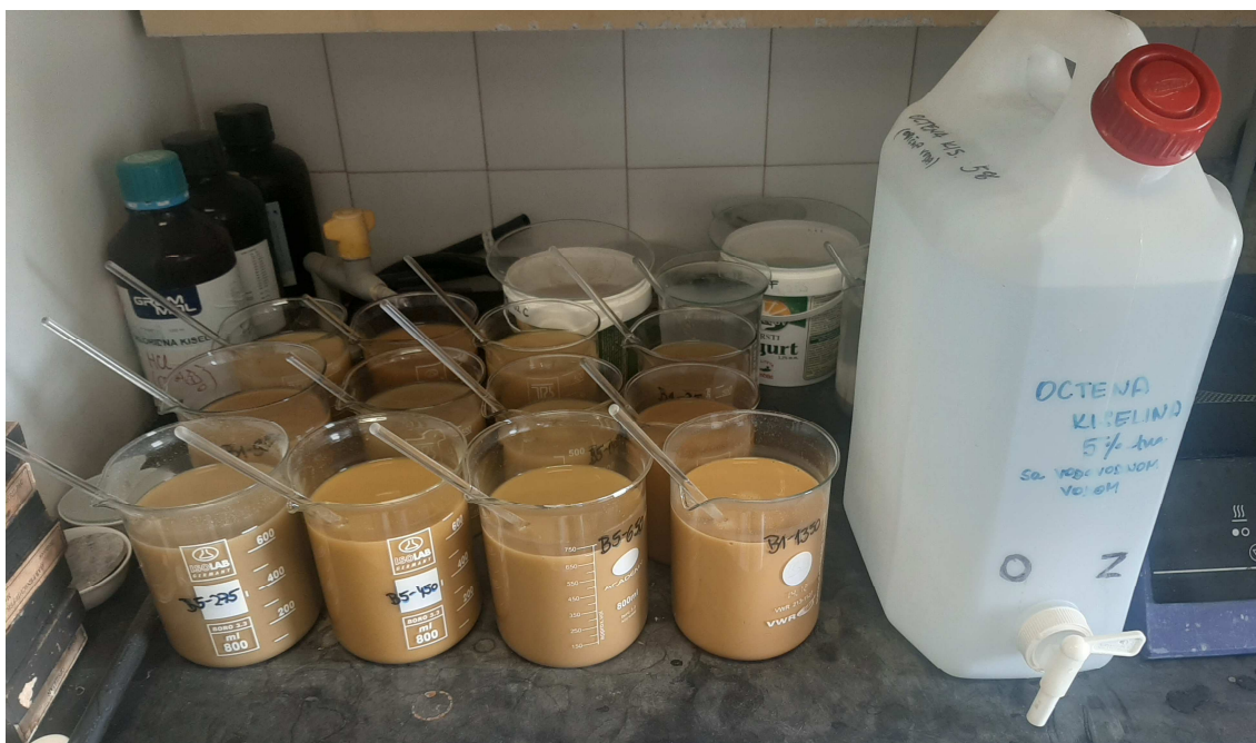
Slika 20. Uklanjanje karbonatne komponente dodatkom 5%-tne octene kiseline.
