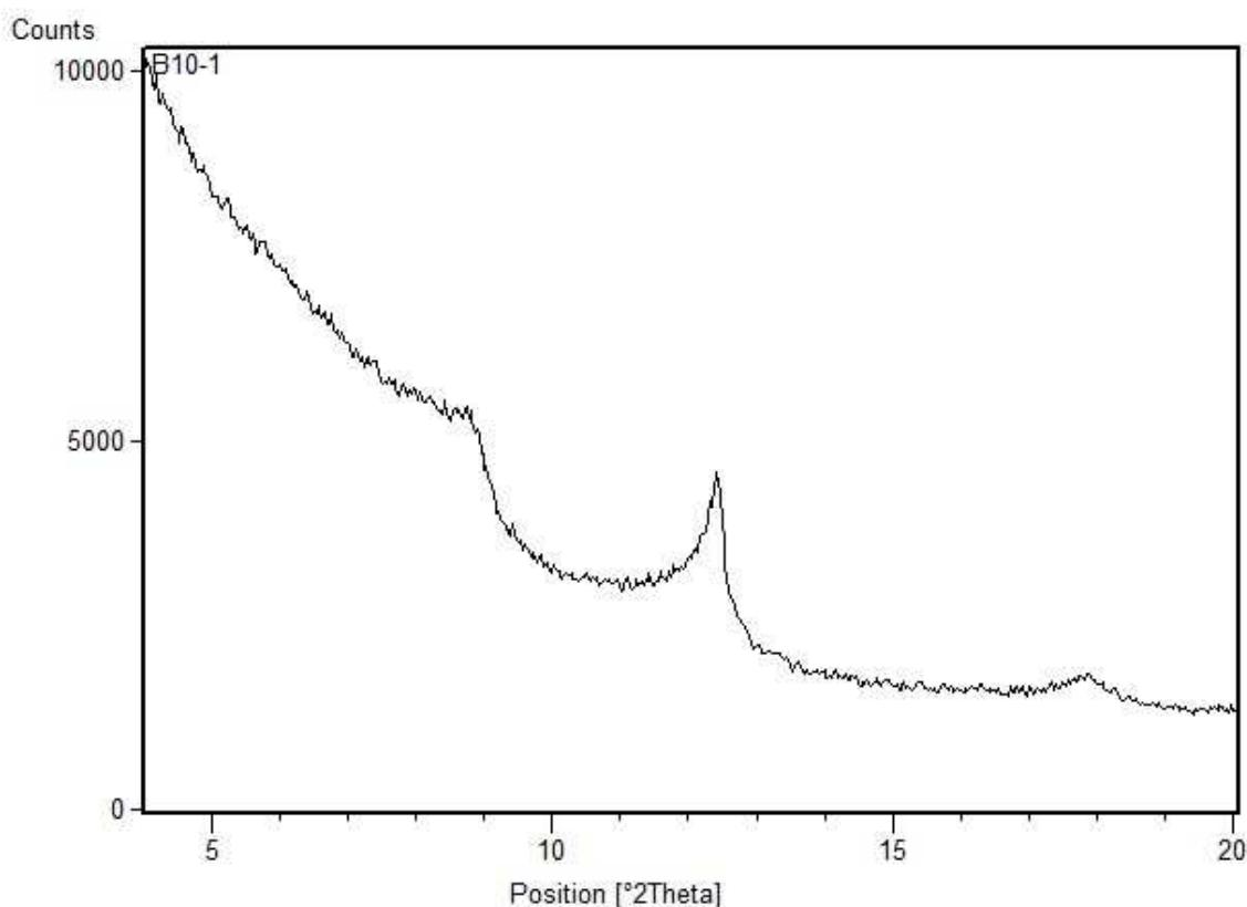
Slika 46. Rendgenogram orijentiranog netretiranog preparata uzorka B10-25.
