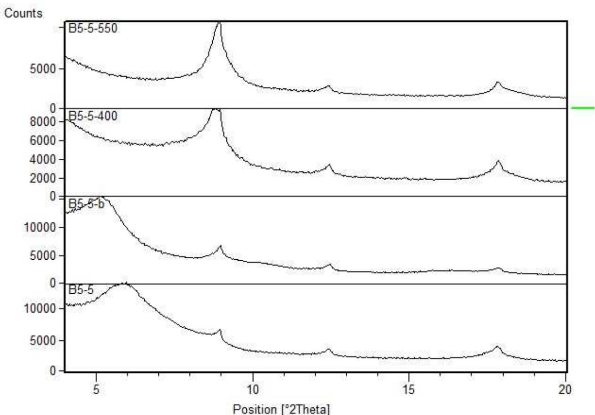
Slika 41. Usporedni rendgenogrami orijentiranih preparata uzorka B5-450 (1 – netretirani uzorak, 1-b – tretirano etilen glikolom, 1 – 400 – žareno na 400°C, 1 – 550 – žareno na 550°C).
