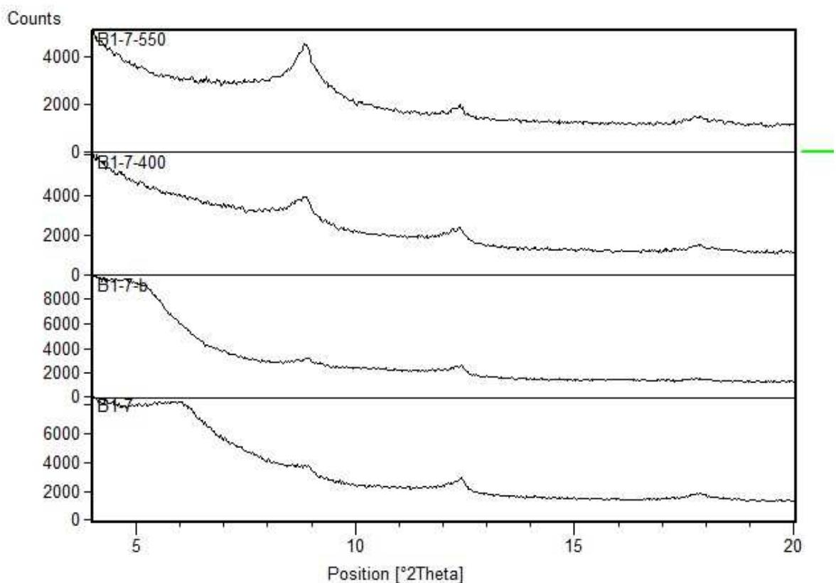
Slika 35. Usporedni rendgenogrami orijentiranih preparata uzorka B1-950 (1 – netretirani uzorak, 1-b – tretirano etilen glikolom, 1 – 400 – žareno na 400°C, 1 – 550 – žareno na 550°C).
