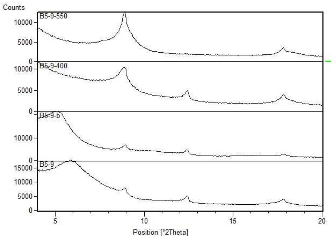
Slika 45. Usporedni rendgenogrami orijentiranih preparata uzorka B5-1450 (1 – netretirani uzorak, 1-b – tretirano etilen glikolom, 1 – 400 – žareno na 400°C, 1 – 550 – žareno na 550°C).
