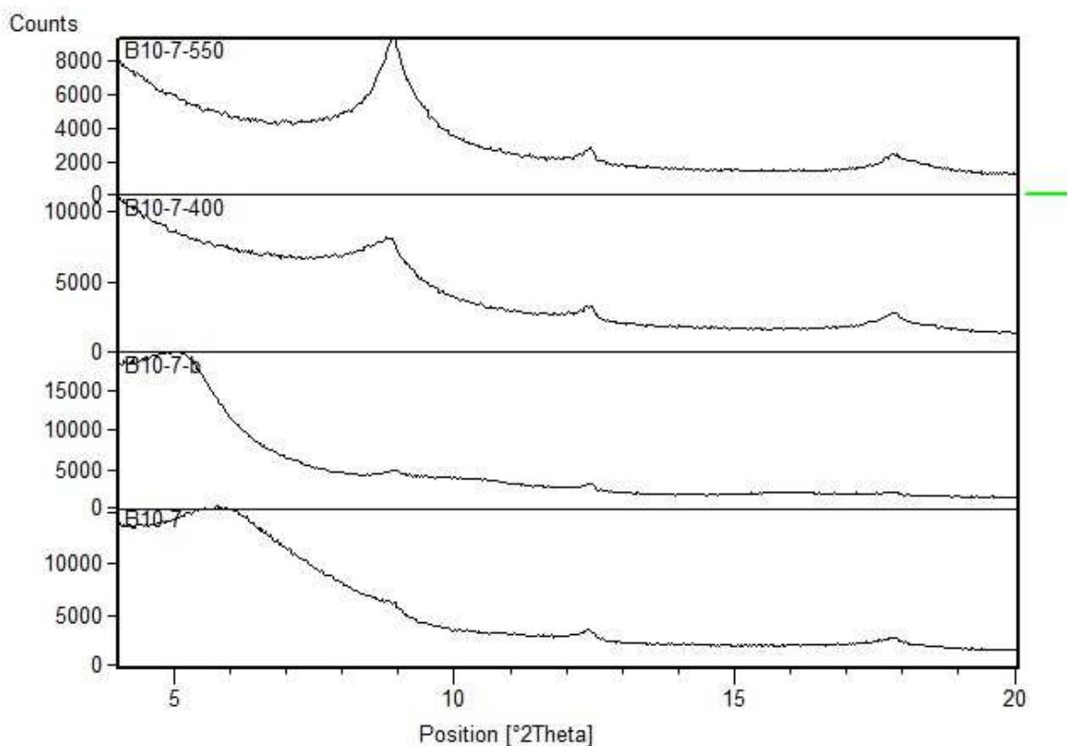
Slika 52. Usporedni rendgenogrami orijentiranih preparata uzorka B10-950 (1 – netretirani uzorak, 1-b – tretirano etilen glikolom, 1 – 400 – žareno na 400°C, 1 – 550 – žareno na 550°C).
