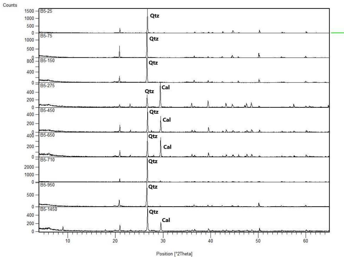
Slika 27. Prikaz usporednih rendgenograma svih uzoraka prikupljenih na B5 bušotini s označenim difrakcijskim maksimumima glavnih faza u uzorku s najvećim relativnim intenzitetima (Qtz – kvarc, Cal – kalcit).
