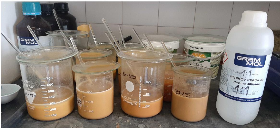
Slika 21. Uklanjanje organske tvari dodatkom 15%-tnog vodikovog peroksida.
