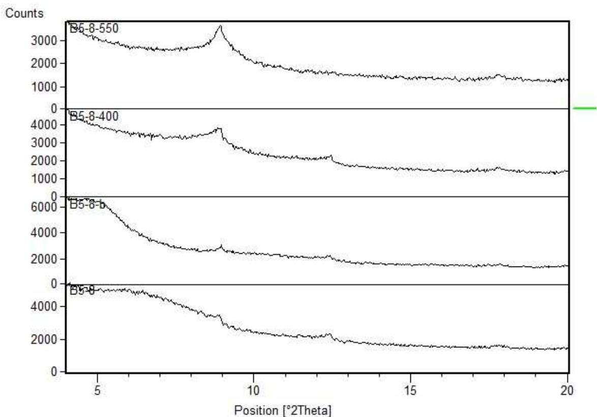
Slika 44. Usporedni rendgenogrami orijentiranih preparata uzorka B5-950 (1 – netretirani uzorak, 1-b – tretirano etilen glikolom, 1 – 400 – žareno na 400°C, 1 – 550 – žareno na 550°C).
