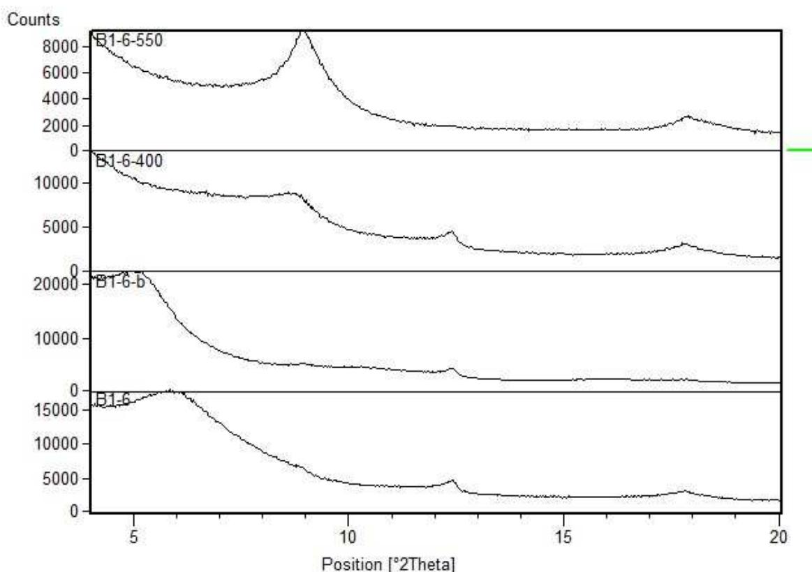
Slika 34. Usporedni rendgenogrami orijentiranih preparata uzorka B1-750 (1 – netretirani uzorak, 1-b – tretirano etilen glikolom, 1 – 400 – žareno na 400°C, 1 – 550 – žareno na 550°C).
