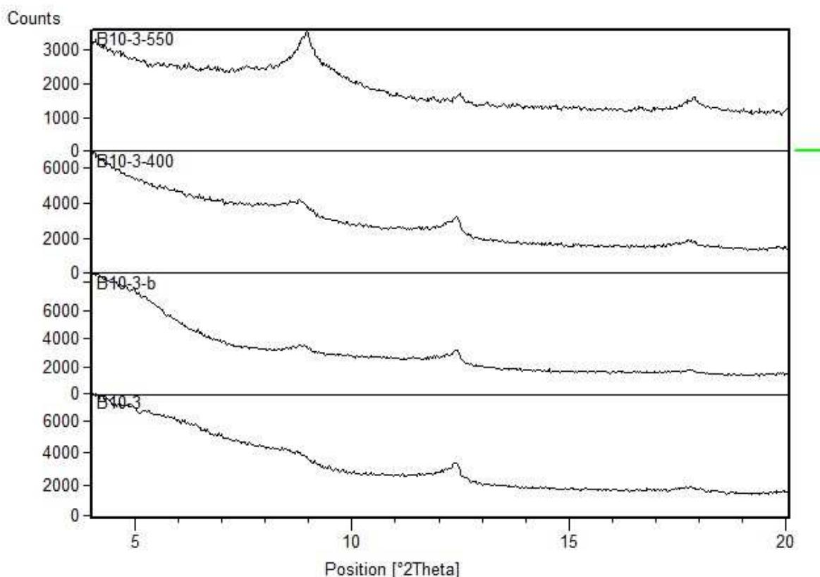
Slika 48. Usporedni rendgenogrami orijentiranih preparata uzorka B10-250 (1 – netretirani uzorak, 1-b – tretirano etilen glikolom, 1 – 400 – žareno na 400°C, 1 – 550 – žareno na 550°C).
