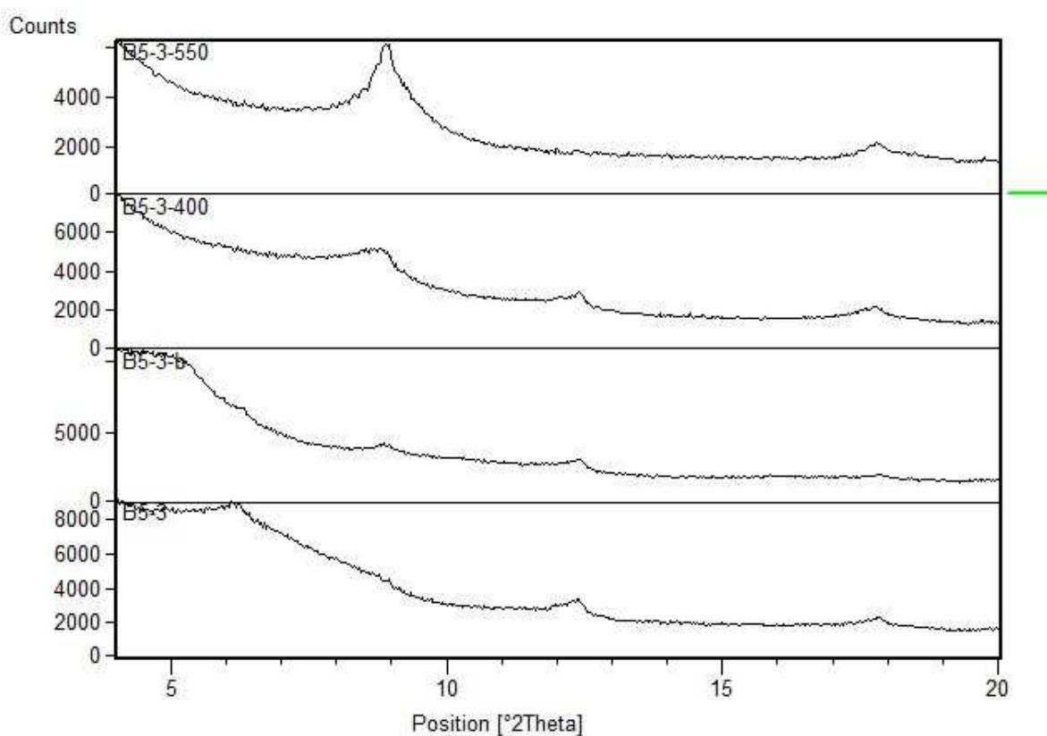
Slika 39. Usporedni rendgenogrami orijentiranih preparata uzorka B5-150 (1 – netretirani uzorak, 1-b – tretirano etilen glikolom, 1 – 400 – žareno na 400°C, 1 – 550 – žareno na 550°C).
