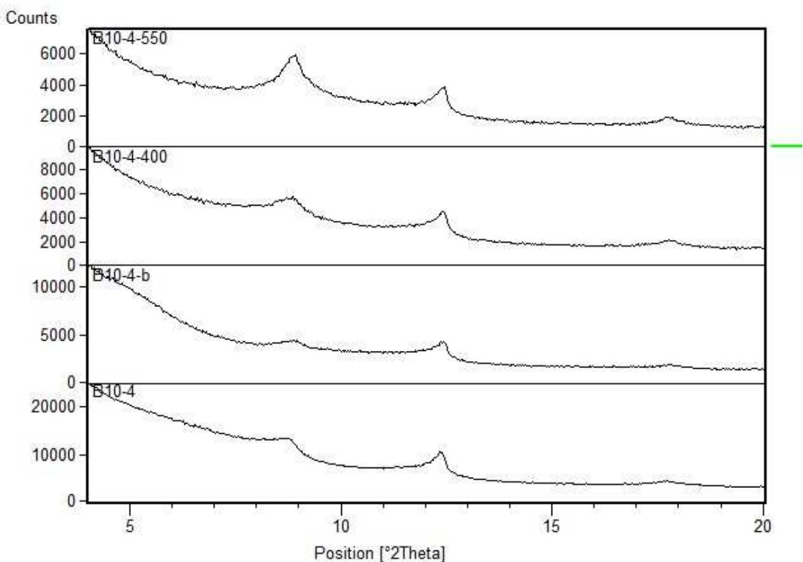
Slika 49. Usporedni rendgenogrami orijentiranih preparata uzorka B10-350 (1 – netretirani uzorak, 1-b – tretirano etilen glikolom, 1 – 400 – žareno na 400°C, 1 – 550 – žareno na 550°C).
