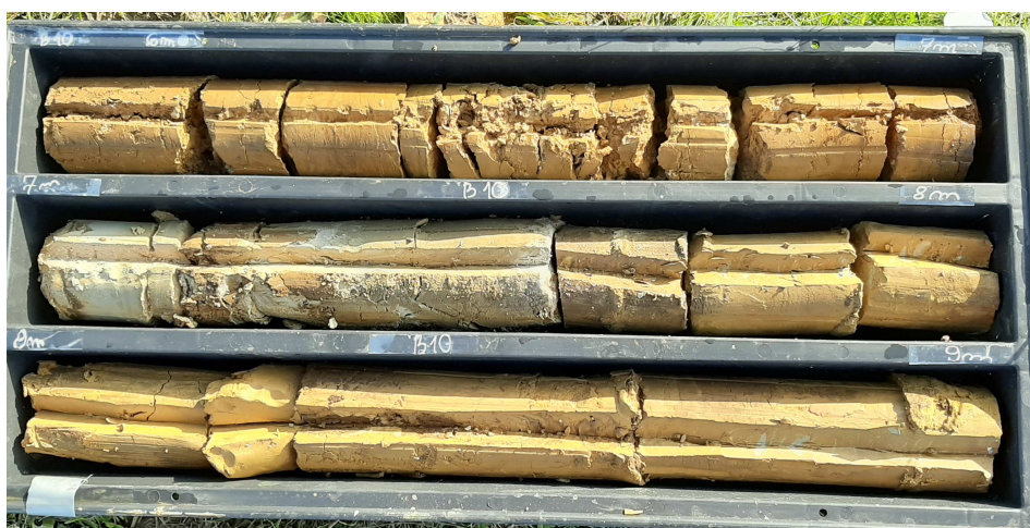
Slika 16. Bušotina B10, 6-9 m dubine.
