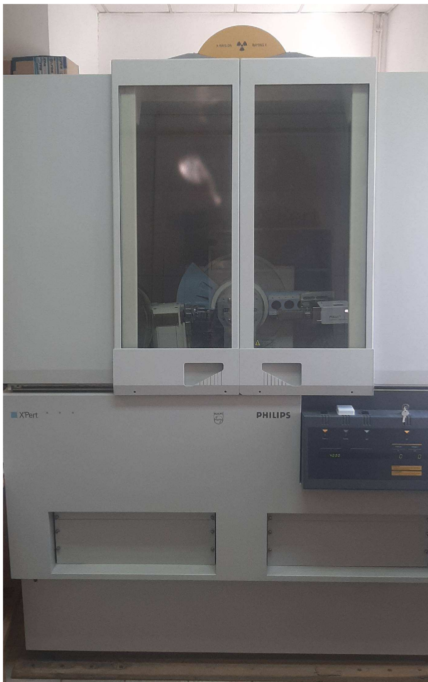
Slika 25. Rendgenski difraktometar Phillips PW3040/60 X'Pert Pro.
