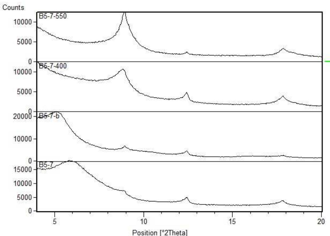
Slika 43. Usporedni rendgenogrami orijentiranih preparata uzorka B5-710 (1 – netretirani uzorak, 1-b – tretirano etilen glikolom, 1 – 400 – žareno na 400°C, 1 – 550 – žareno na 550°C).
