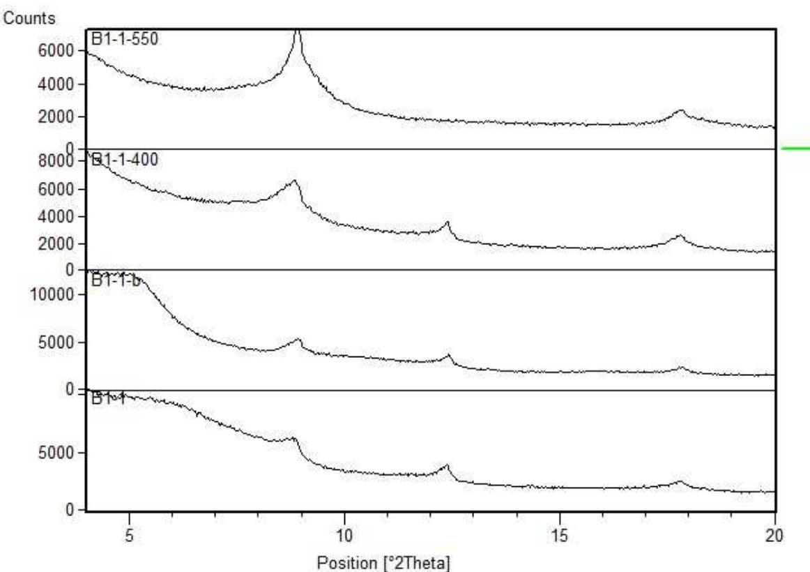
Slika 29. Usporedni rendgenogrami orijentiranih preparata uzorka B1-25 (1 – netretirani uzorak, 1-b – tretirano etilen glikolom, 1 – 400 – žareno na 400°C, 1 – 550 – žareno na 550°C).
