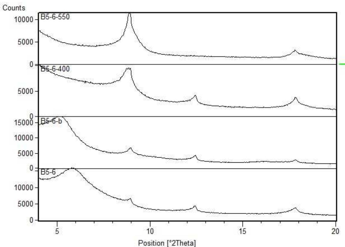
Slika 42. Usporedni rendgenogrami orijentiranih preparata uzorka B5-650 (1 – netretirani uzorak, 1-b – tretirano etilen glikolom, 1 – 400 – žareno na 400°C, 1 – 550 – žareno na 550°C).
