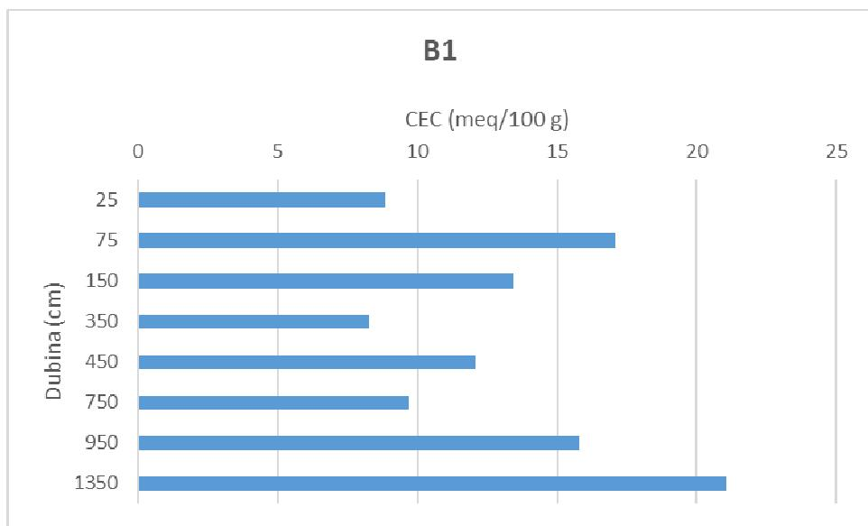
Slika 53. Vrijednosti CEC-a uzorka prve bušotine (B1) u ovisnosti s porastom dubine.
