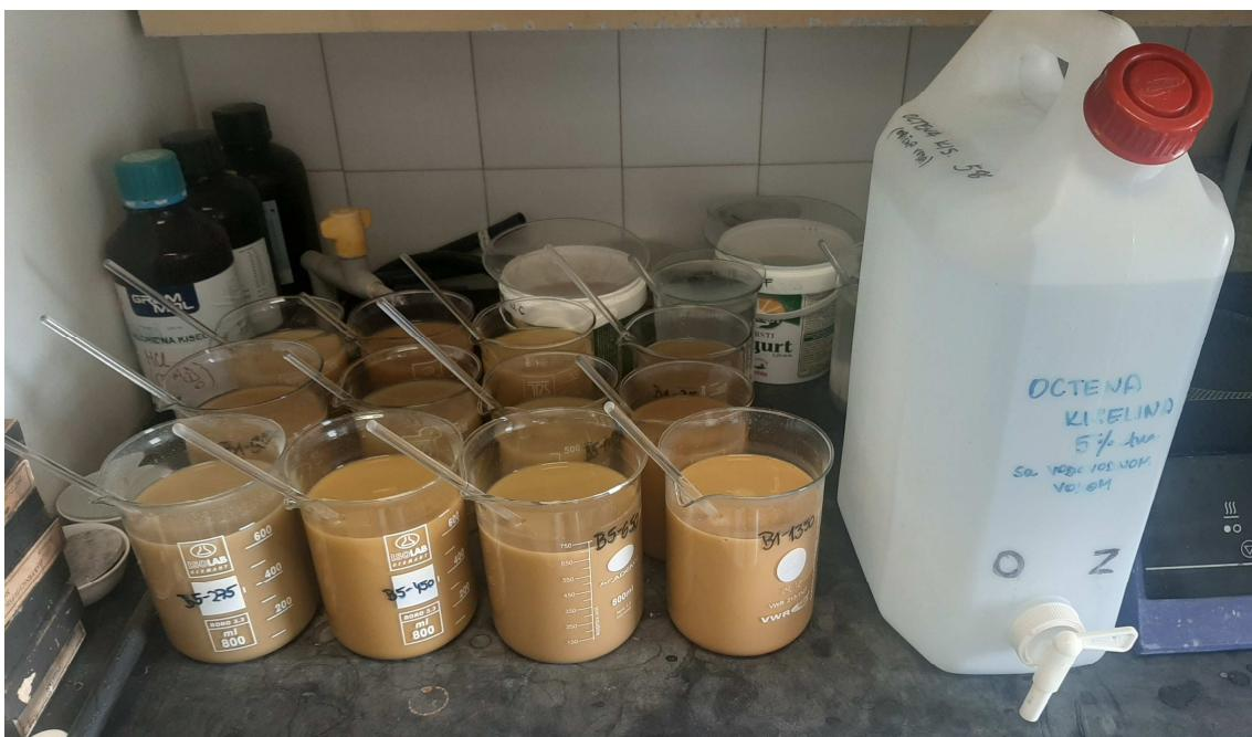
Slika 20. Uklanjanje karbonatne komponente dodatkom 5%-tne octene kiseline.
