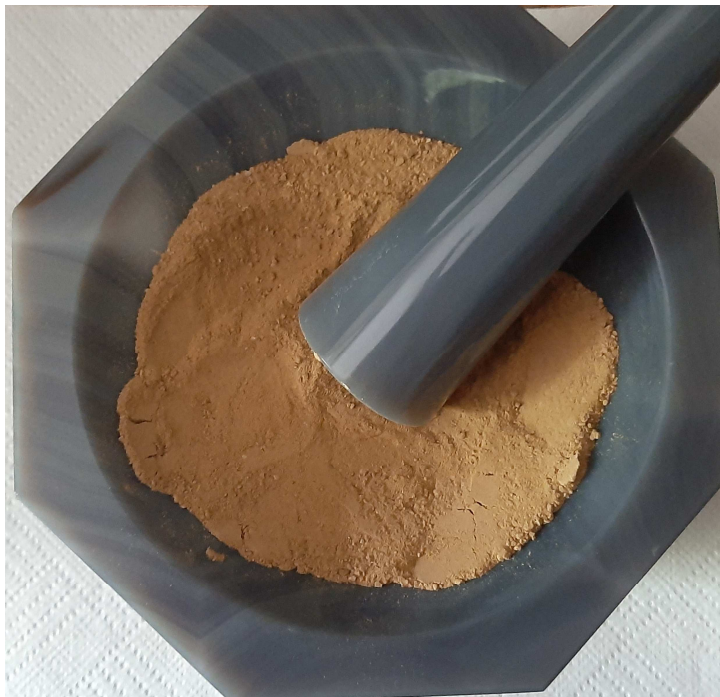
Slika 18. Usitnjavanje uzorka u ahatnom tarioniku.
