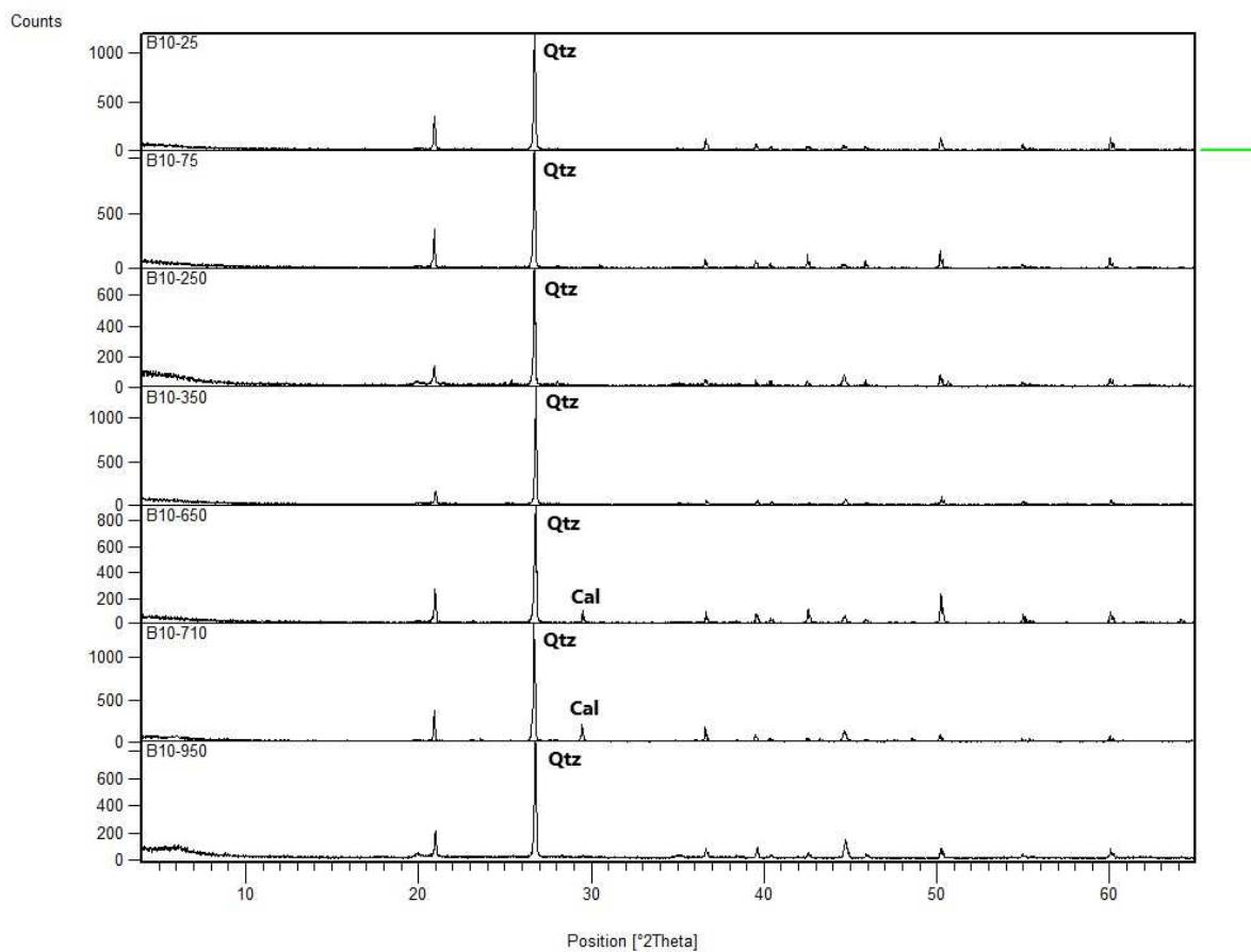
Slika 28. Prikaz usporednih rendgenograma svih uzoraka prikupljenih na B10 bušotini s označenim difrakcijskim maksimumima glavnih faza u uzorku s najvećim relativnim intenzitetima (Qtz – kvarc, Cal – kalcit).
