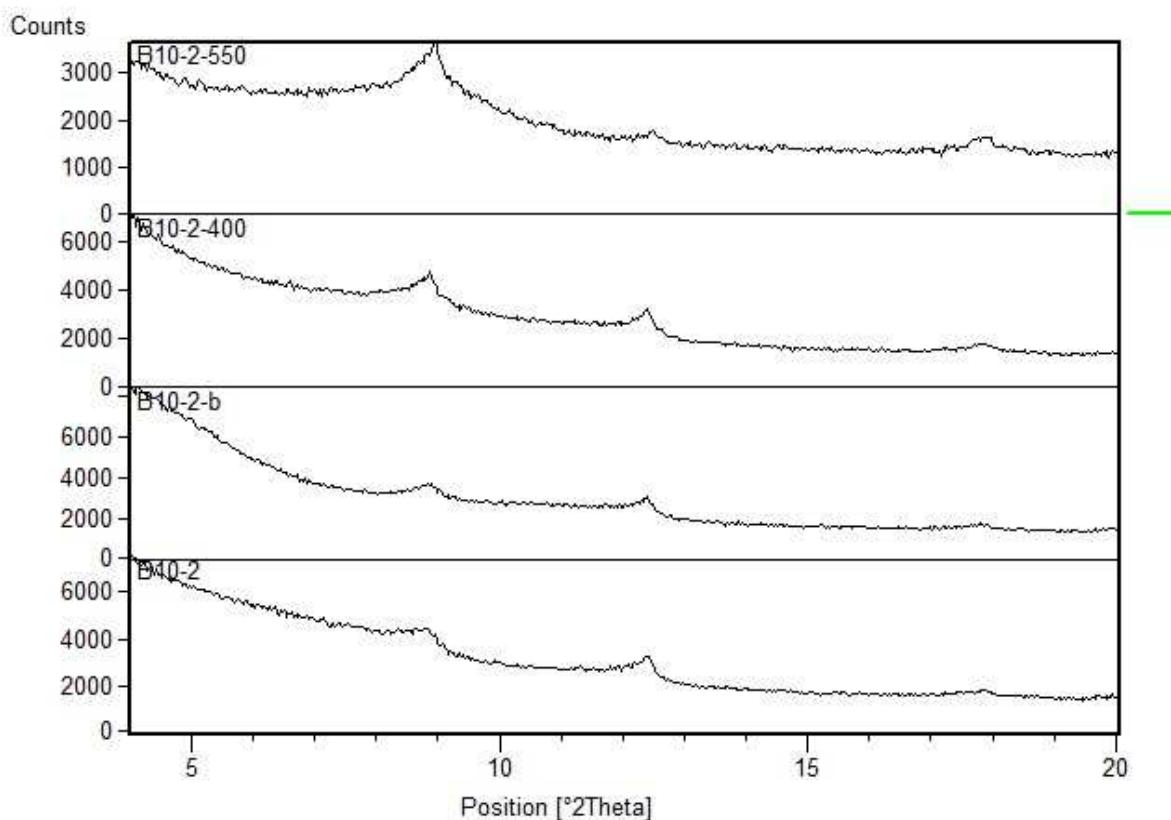
Slika 47. Usporedni rendgenogrami orijentiranih preparata uzorka B10-75 (1 – netretirani uzorak, 1-b – tretirano etilen glikolom, 1 – 400 – žareno na 400°C, 1 – 550 – žareno na 550°C).
