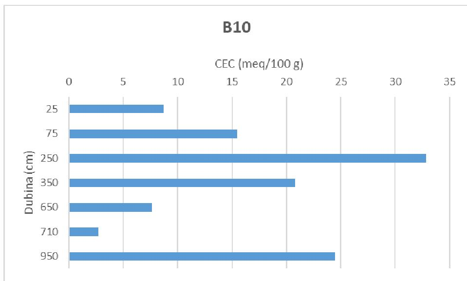
Slika 55. Vrijednosti CEC-a uzorka treće bušotine (B10) u ovisnosti s porastom dubine.
