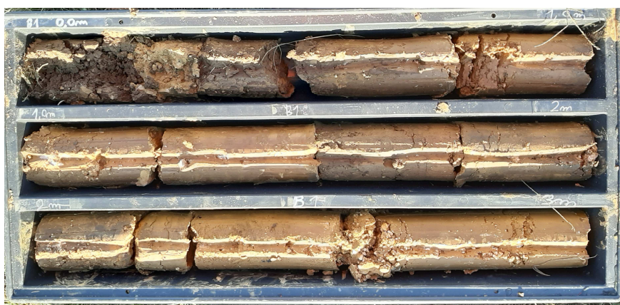
Slika 5. Bušotina B1, 0-3 m dubine.
