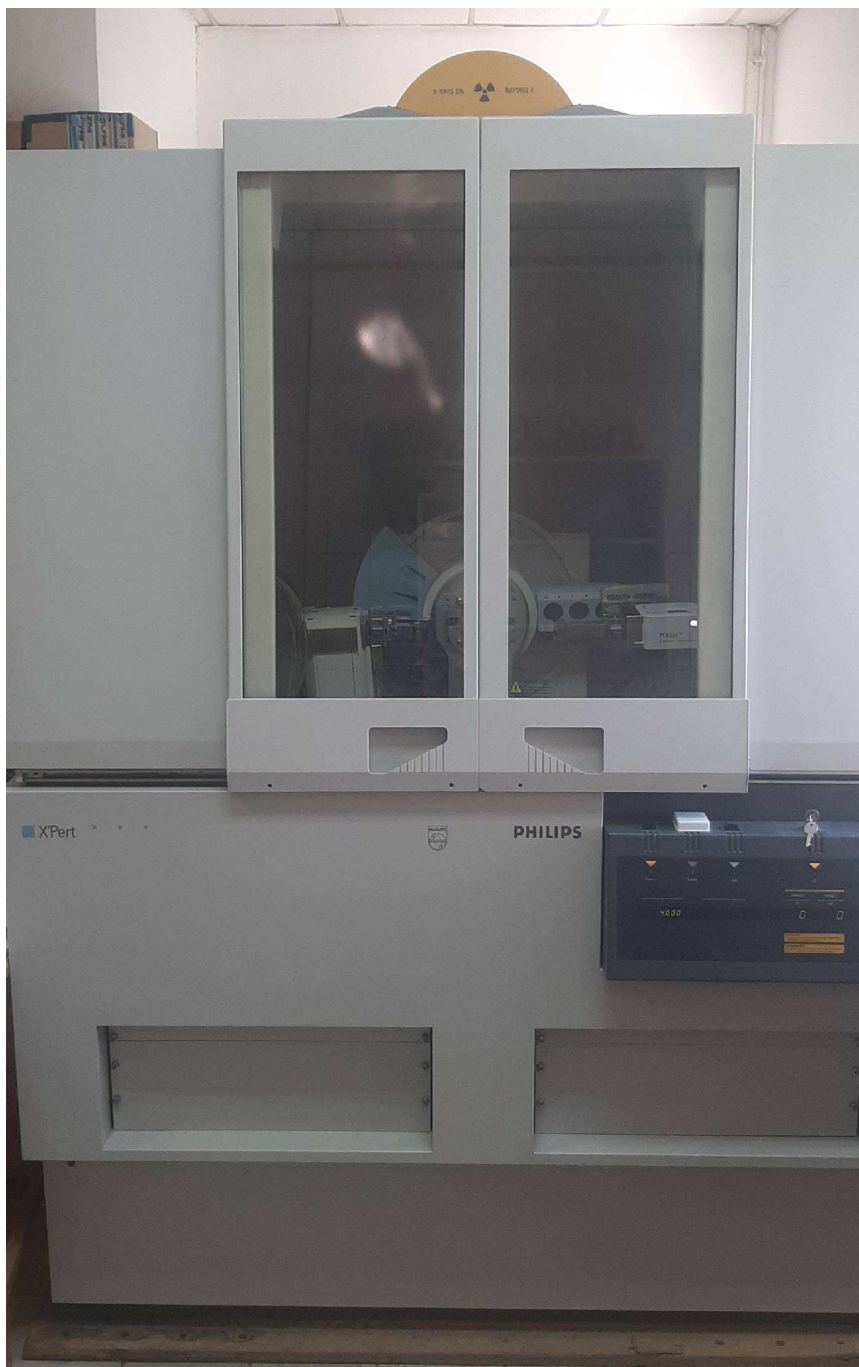
Slika 25. Rendgenski difraktometar Phillips PW3040/60 X'Pert Pro.
