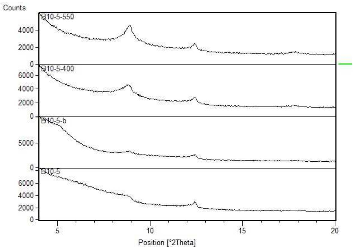
Slika 50. Usporedni rendgenogrami orijentiranih preparata uzorka B10-650 (1 – netretirani uzorak, 1-b – tretirano etilen glikolom, 1 – 400 – žareno na 400°C, 1 – 550 – žareno na 550°C).
