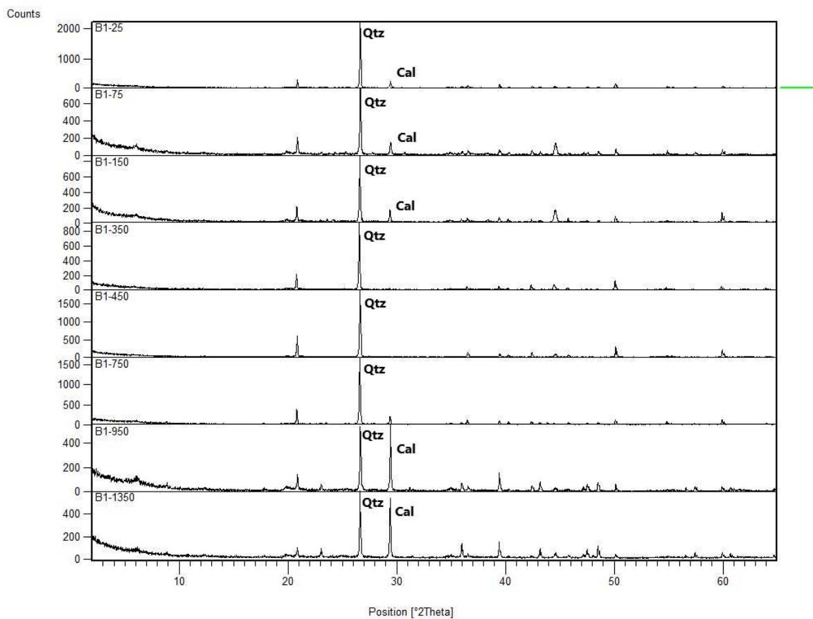
Slika 26. Prikaz usporednih rendgenograma svih uzoraka prikupljenih na B1 bušotini s označenim difrakcijskim maksimumima glavnih faza u uzorku s najvećim relativnim intenzitetima (Qtz – kvarc, Cal – kalcit).
